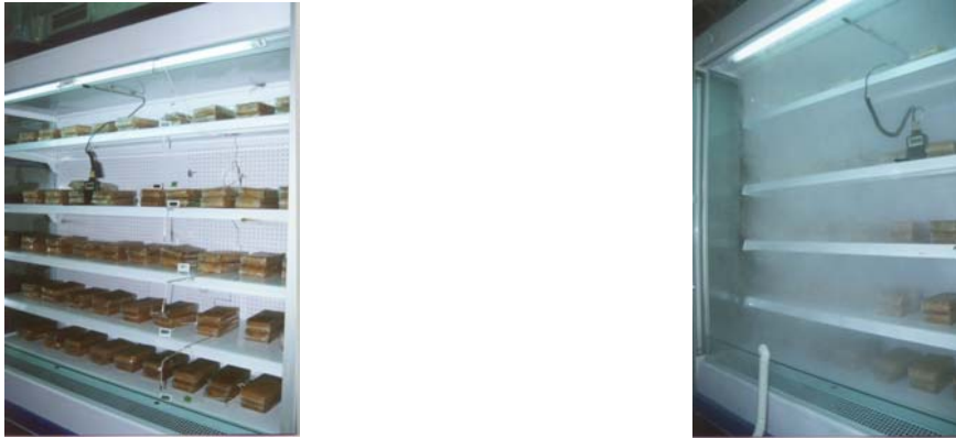
a) Disposição genérica dos elementos de sensorização. b) Visualização do escoamento por injeção de fumo.
