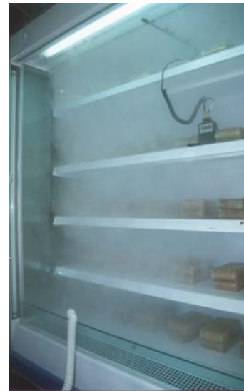
b) Visualização do escoamento: injeção de fumo.
