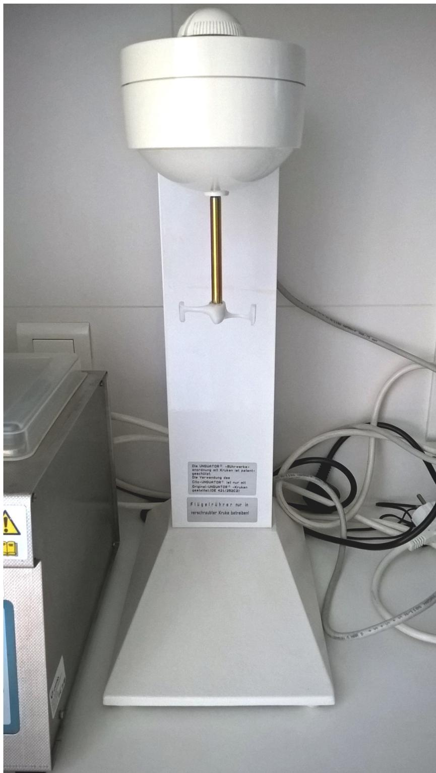
Figura B.1: Equipamento mecânico de pulverização de pós e mistura/homogeneização de preparações semi-sólidas.
