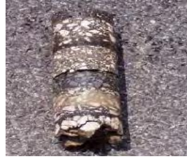
Figura 3.2- Carote retirado por sondagem (Antunes, M. et al., 2005 citado por Santos, M., 2009)
