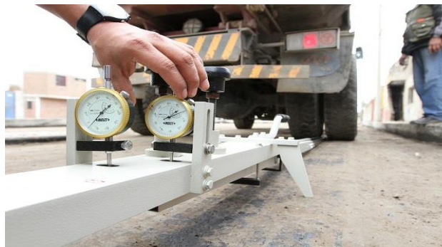
Figura 2.20- Ensaio da viga de Benkelman (Trujilloinforma, 2014. Disponível em: http://trujilloinforma.com/trujillo/aplican-pruebas-de-resistencia-a-superficie-vial-de-av-villareal/ )
