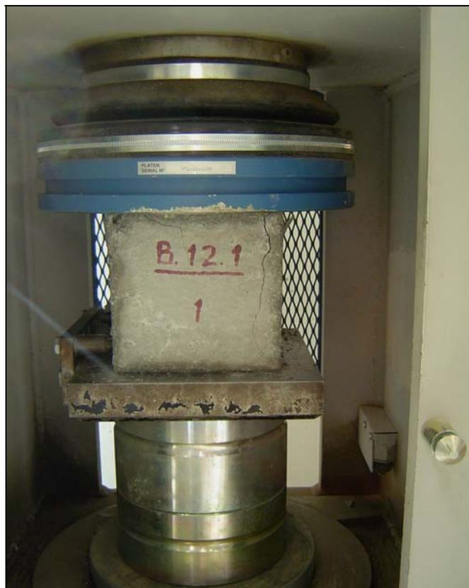
**Figura 7.83** – Rotura de um provete de betão à compressão
