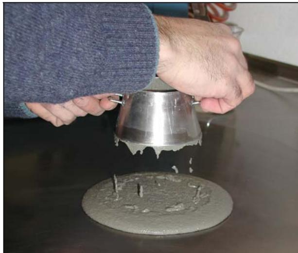
**Figura 7.26** – Fase 2 do ensaio de espalhamento
