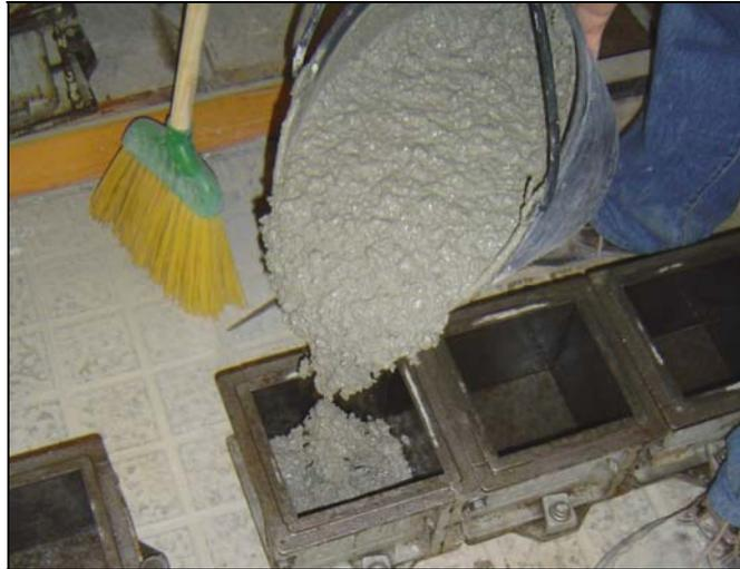
**Figura 7.79** – Moldagem de provetes para o ensaio à compressão: Fase 1
