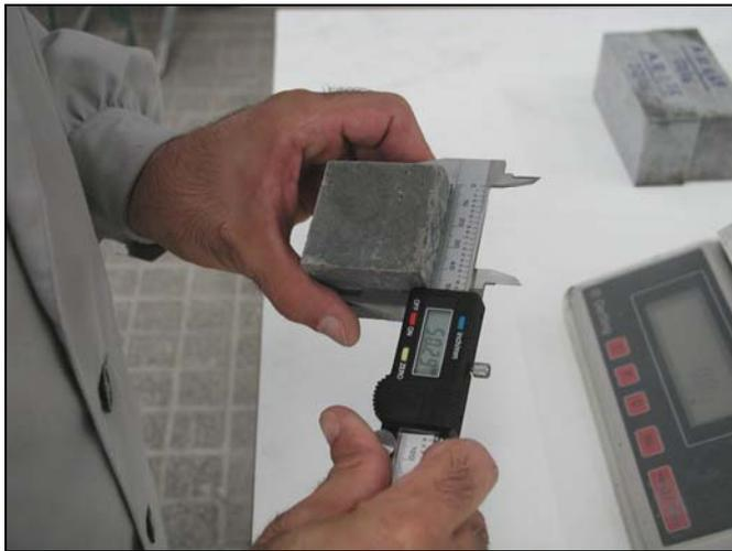
**Figura 7.41** – Medição das dimensões dos provetes
