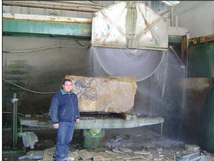
**Figura 7.4** – Processo de corte das rochas
