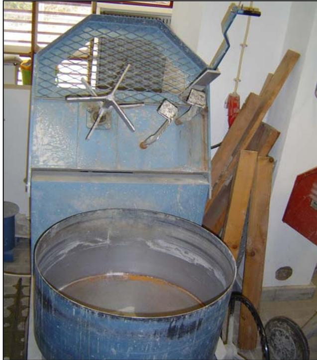
**Figura 7.54** – Betoneira misturadora utilizada na produção dos betões
