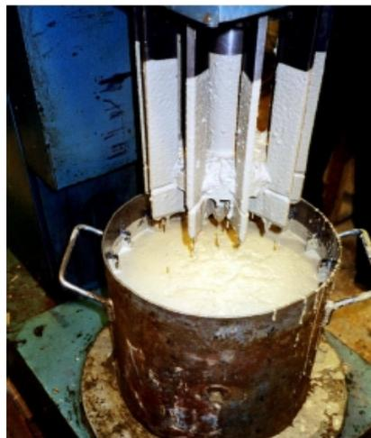
**Figura 4.3** - Reómetro BML [2]
