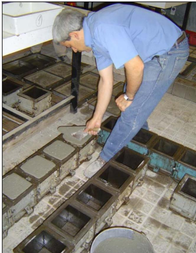
**Figura 7.80** – Moldagem de provetes para o ensaio à compressão: Fase 2
