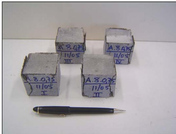
**Figura 7.44** – Geometria de rotura dos provetes - vista 1
