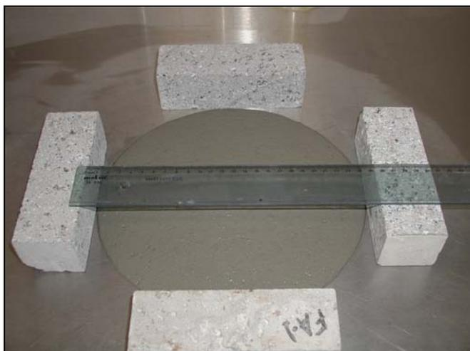
**Figura 7.27** – Fase 3 do ensaio de espalhamento
