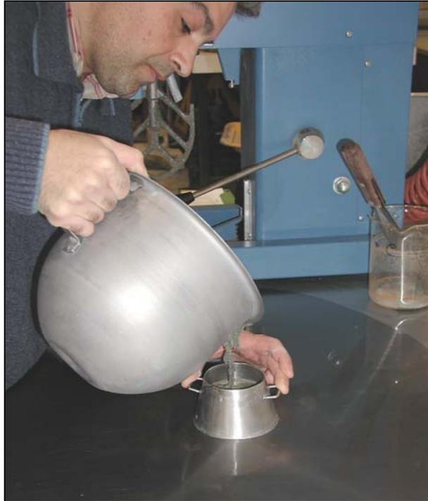
**Figura 7.25** – Fase 1 do ensaio de espalhamento
