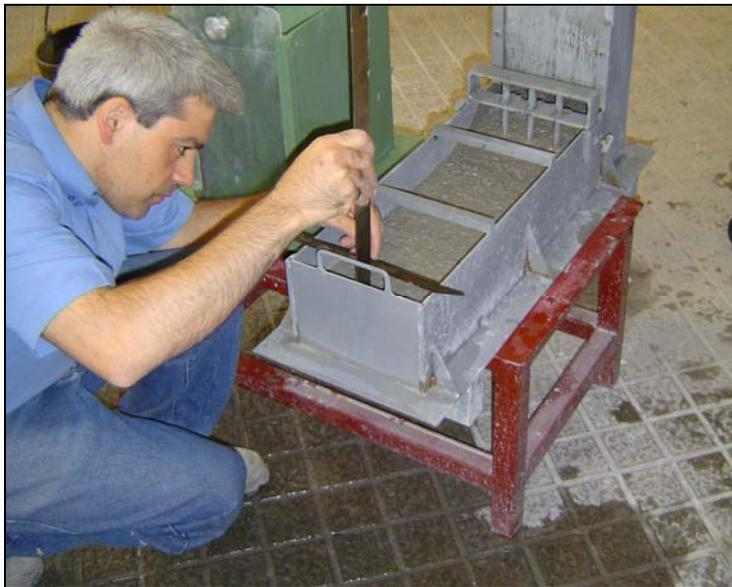
**Figura 7.72** – Medição para determinação da altura H2 na Caixa-L
