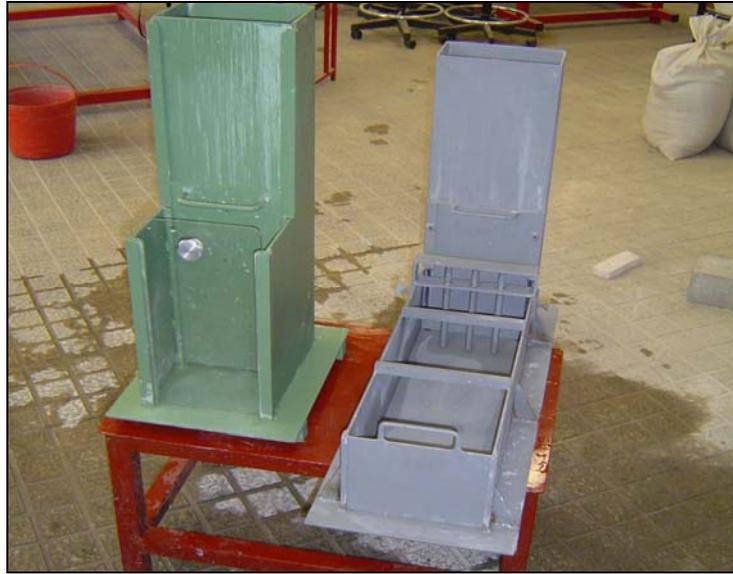
**Figura 7.65** – Preparação do ensaio com a Caixa-L
