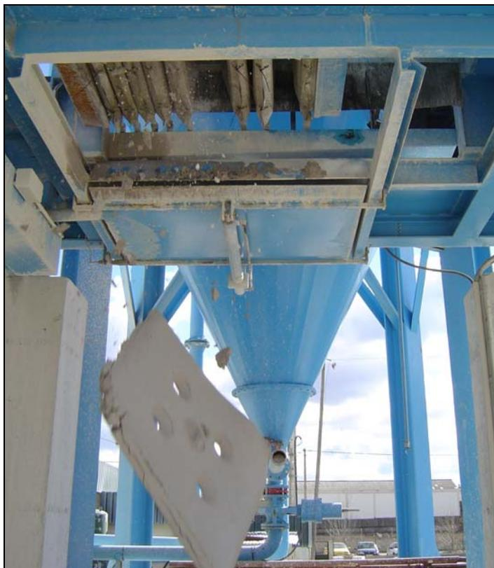
**Figura 7.7** – Sistema de separação dos finos
