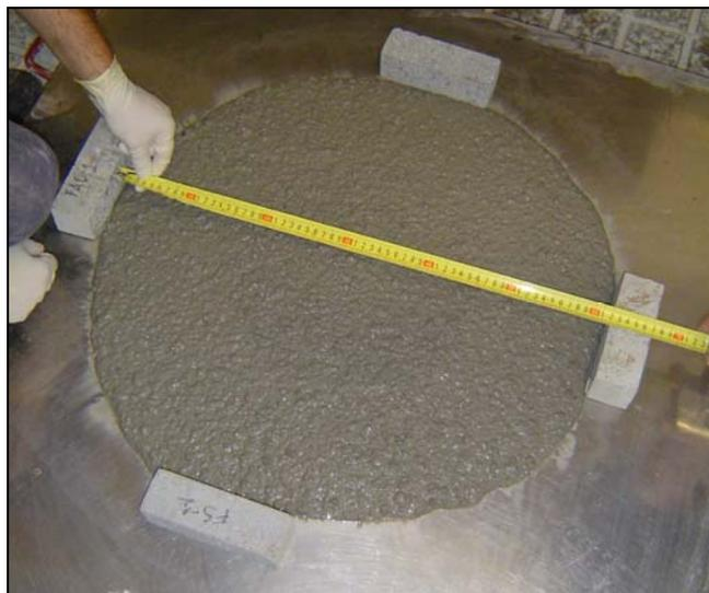
**Figura 7.61** – Medição do diâmetro de espalhamento: Fase 2
