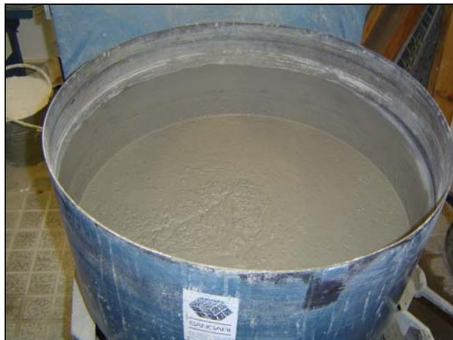
**Figura 7.55** – Aspecto do betão após uma das amassaduras efectuadas
