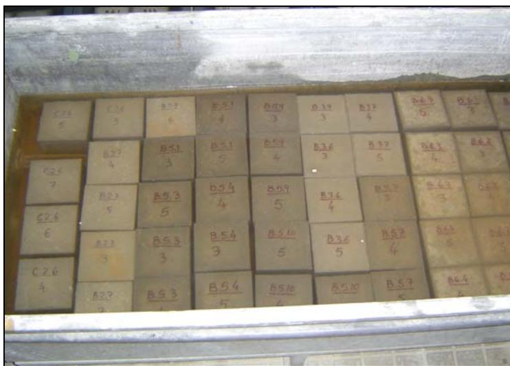
**Figura 7.81** – Tanque de cura
