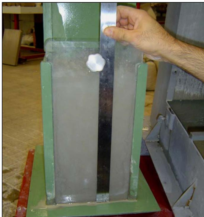
**Figura 7.77** – Medição da altura da coluna de betão na Caixa
