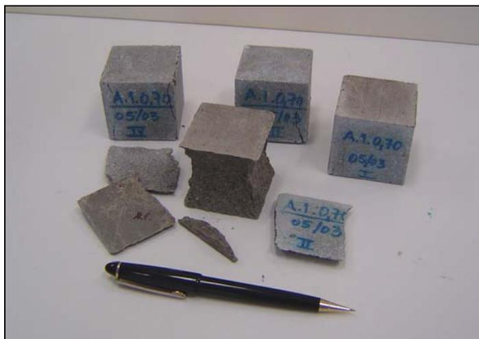
**Figura 7.46** – Geometria de rotura dos provetes - vista 3
