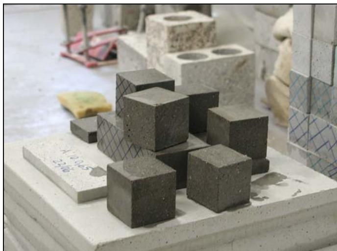
**Figura 7.38** – Provetes resultantes do corte
