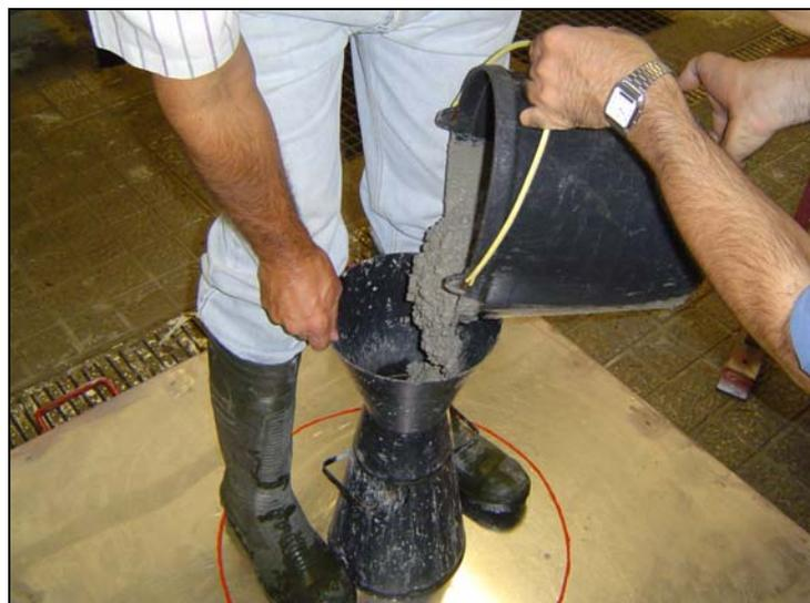
**Figura 7.58** – Enchimento do cone no ensaio de espalhamento
