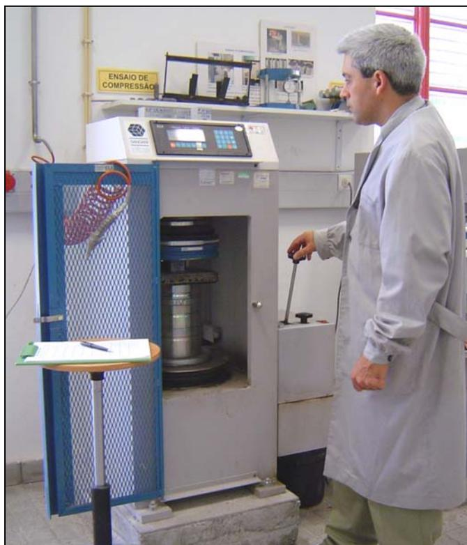
**Figura 7.42** – Ensaio à compressão das argamassas
