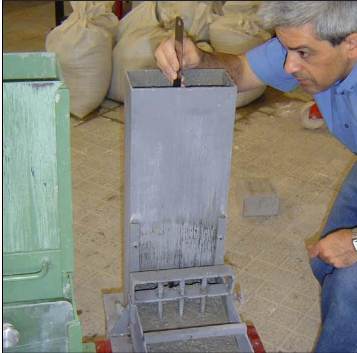
**Figura 7.71** – Medição para determinação da altura H1 na Caixa-L
