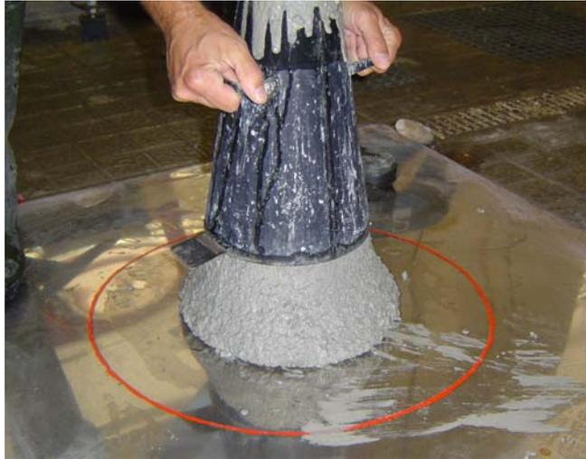
**Figura 7.59** – Levantamento do cone
