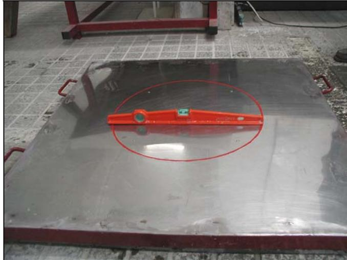
**Figura 7.56** – Preparação do ensaio de espalhamento: Fase 1
