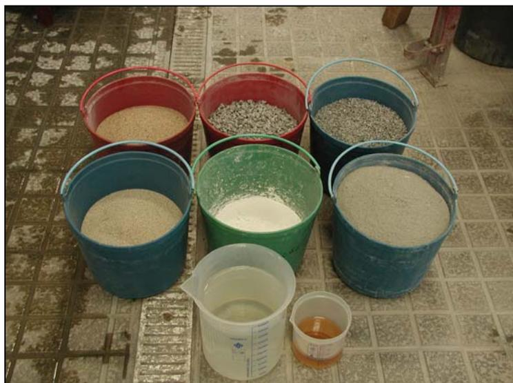
**Figura 7.52** – Exemplo dos materiais utilizados numa amassadura de betão
