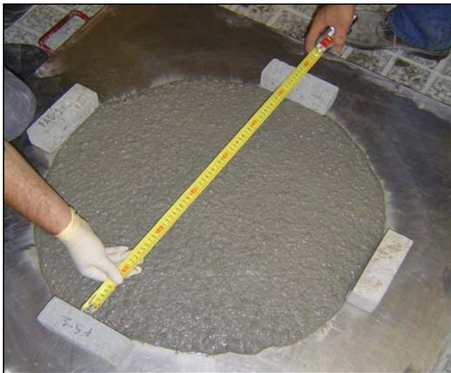
**Figura 7.60** – Medição do diâmetro de espalhamento: Fase 1
