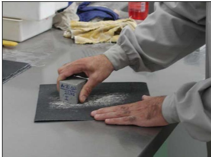
**Figura 7.40** – Polimento dos provetes
