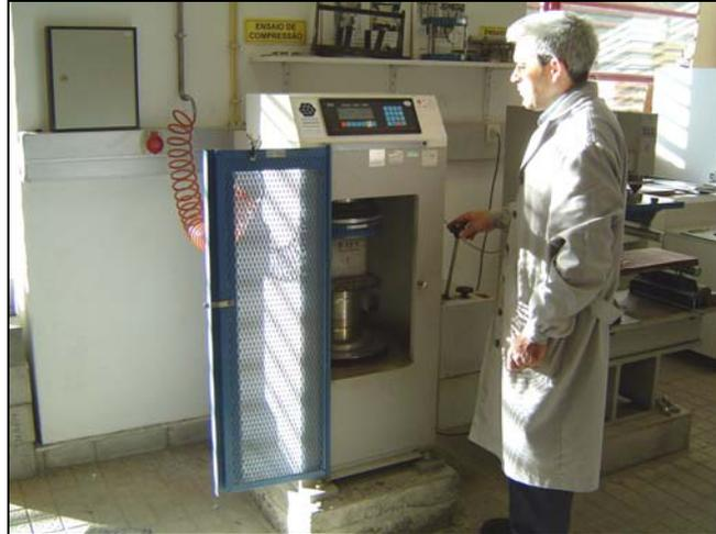
**Figura 7.82** – Prensa utilizada no ensaio à compressão de betões
