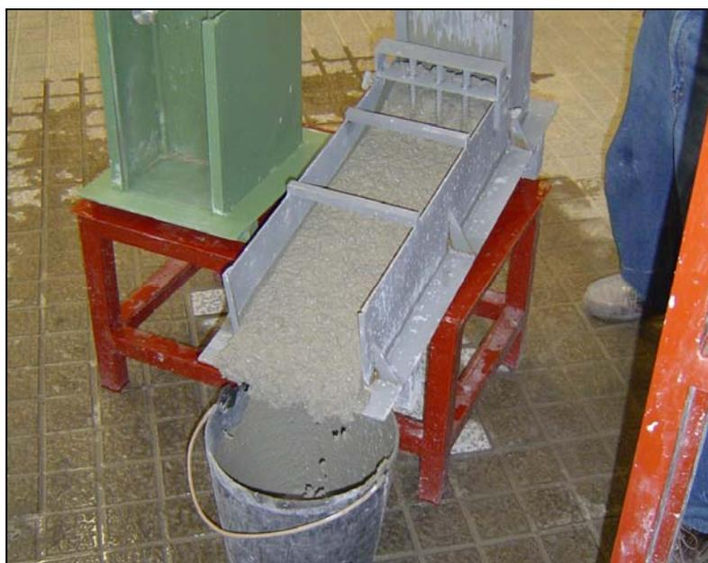
**Figura 7.73** – Mecanismo de descarga para limpeza da Caixa-L
