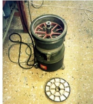
**Figura 4.2** - Reómetro BTRHEOM [2]
