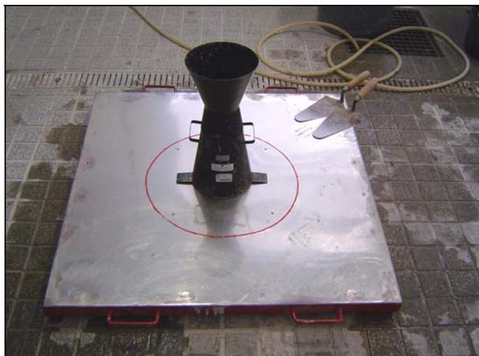
**Figura 7.57** – Preparação do ensaio de espalhamento: Fase 2
