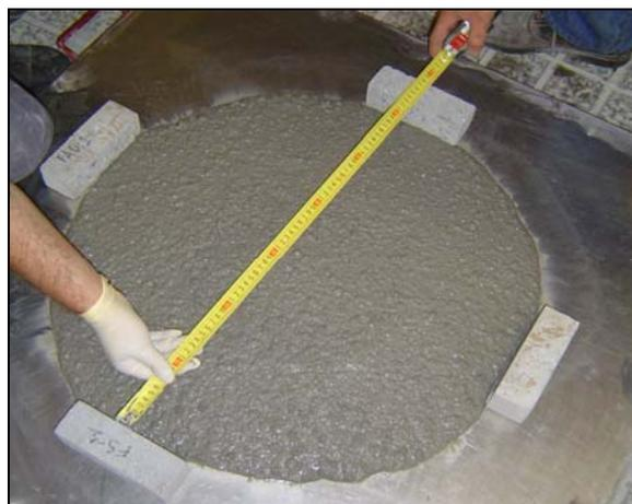
**Figura 4.8** – Medição do diâmetro
