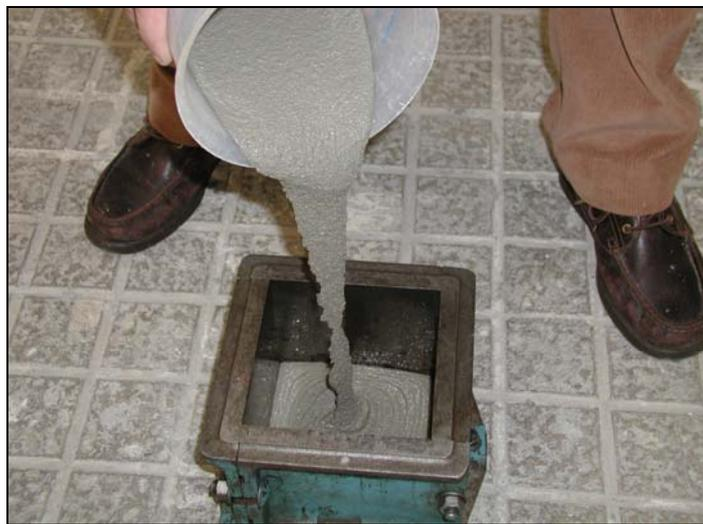
**Figura 7.31** – Enchimento do molde para amostragem
