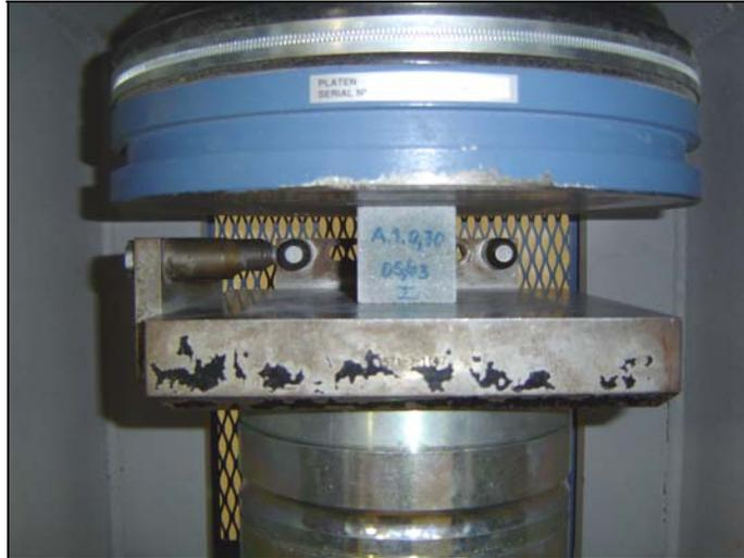
**Figura 7.43** – Ensaio à compressão das argamassas - pormenor
