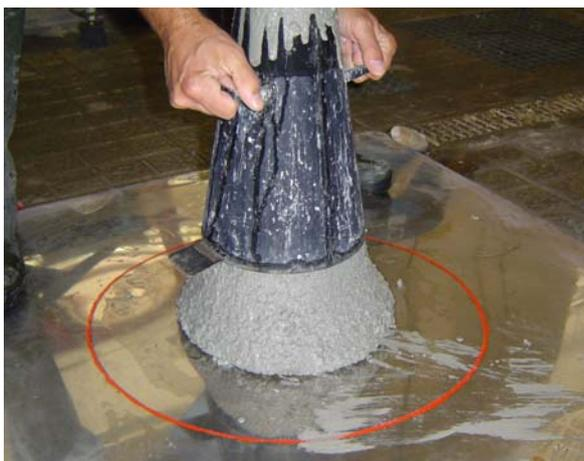
**Figura 4.7** – Ensaio de espalhamento
