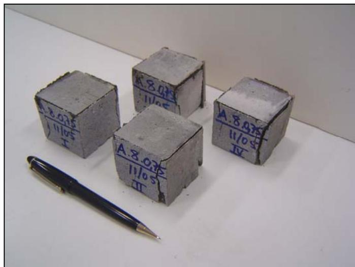
**Figura 7.45** – Geometria de rotura dos provetes - vista 2
