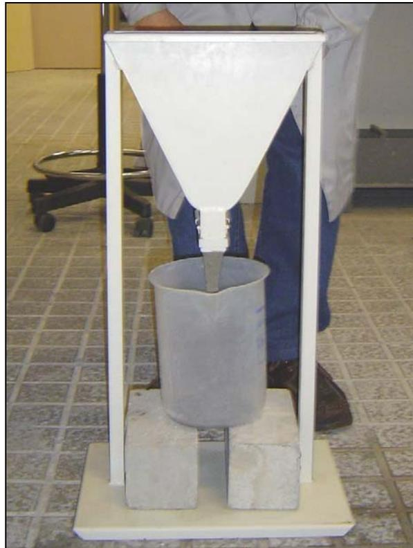
**Figura 7.30** – Escoamento da argamassa no Funil-V
