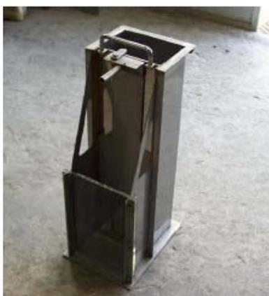
**Figura 4.17** – Ensaio da “Caixa” [50]
