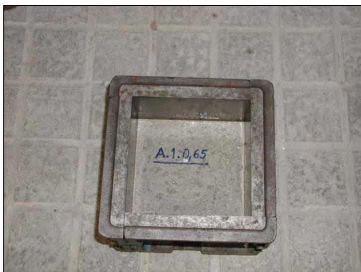
**Figura 7.32** – Identificação dos provetes para o ensaio de compressão
