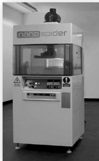
Figura 7- Sistema de electrospinning utilizado.
