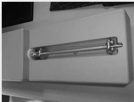
Figura 8- Elétrodo de spinning cilíndrico de arames.
