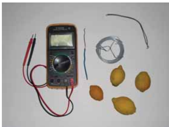
Figura 53 Material necessários para a realização da experiência do limão: cobre, zinco, multímetro, led e limões.
