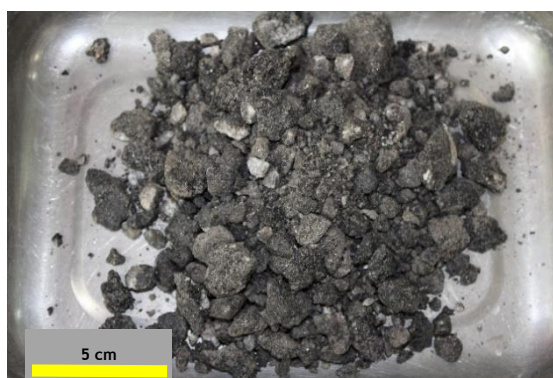
Figura 4.2 - Material fresado do nó de Vila Velha de Ródão
