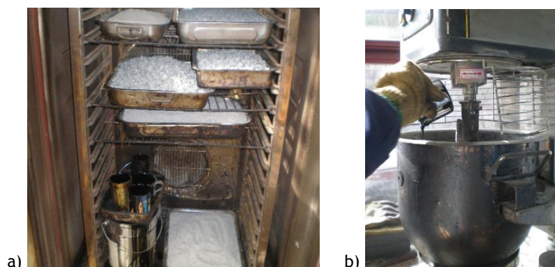
Figura 4.22 - Processo de fabrico das misturas betuminosas (DECA-UBI)
