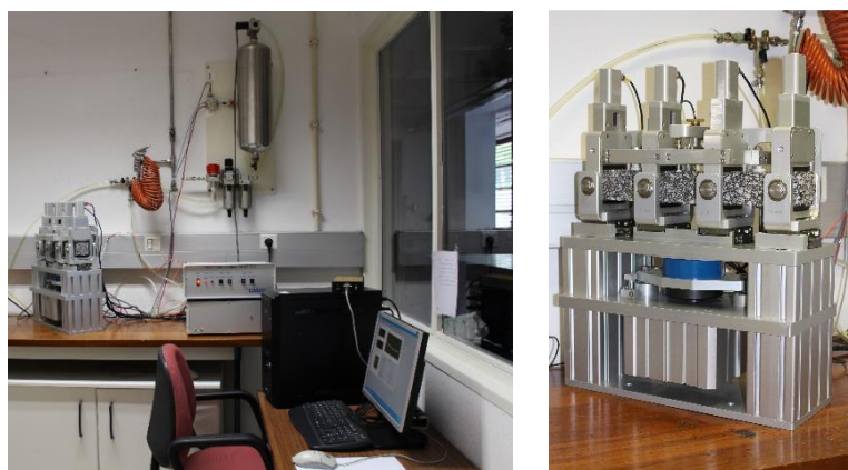
Figura 3.6 - Equipamento para o ensaio 4PB-PR (DECA-UBI)
