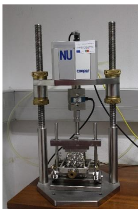
Figura 3.10 - Equipamento para o ensaio IT-CY (DECA-UBI)
