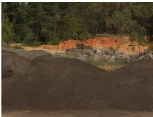
Figura 2.4 - Depósito de material proveniente de fresagem, EN244 (adaptado de Dinis-Almeida, 2010)
