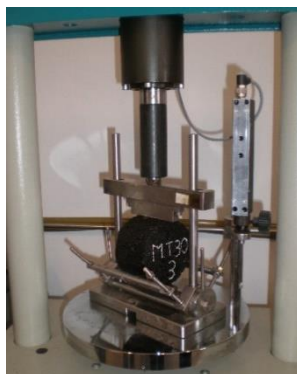
Figura 4.19 - Ensaio de tração indireta em compressão diametral (InfraLab)
