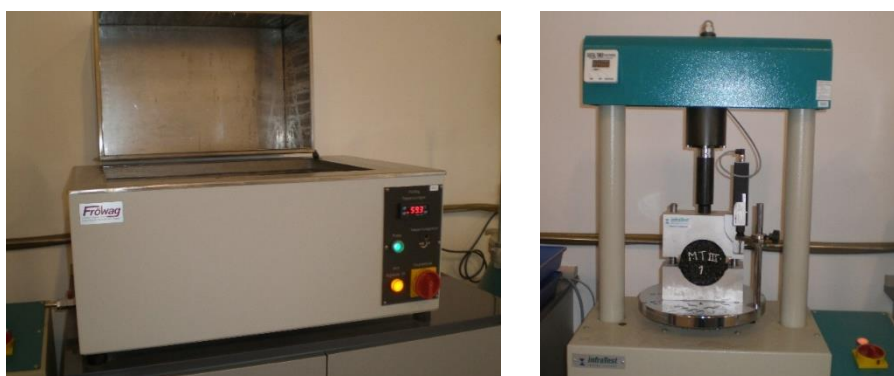
Figura 4.12 - Câmara de banho de imersão e prensa de compressão Marshall (InfraLab)
