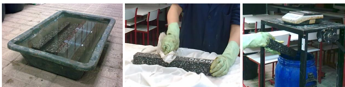
Figura 4.25 - Procedimento para o cálculo da baridade (DECA-UBI)
