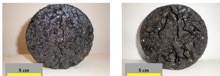
Figura 4.21 - Provetes com roturas do tipo a) e b)
