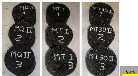
Figura 4.17 - Provetes cilíndricos após ensaio de tração indireta em compressão diametral
