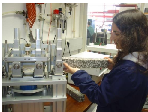
Figura 4.26 - Colocação de provete prismático no equipamento (DECA-UBI)
