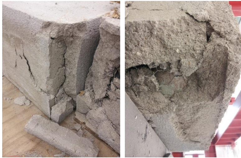
Figura 6.9. Visualização da desintegração da argamassa no ensaio após 28 dias
