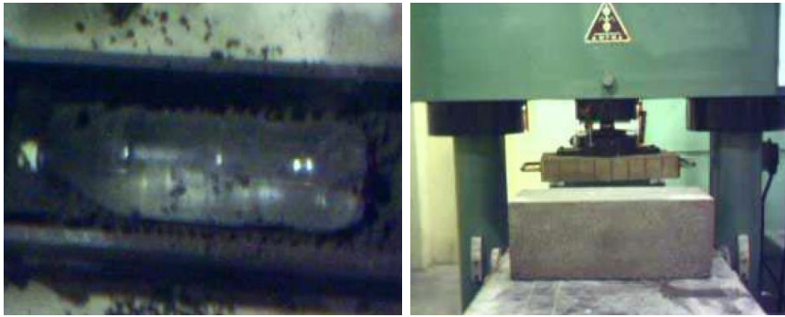
Figura 2.8. Construção do bloco PET e ensaio a compressão (Fonte: Ferreira et al., 2007)
