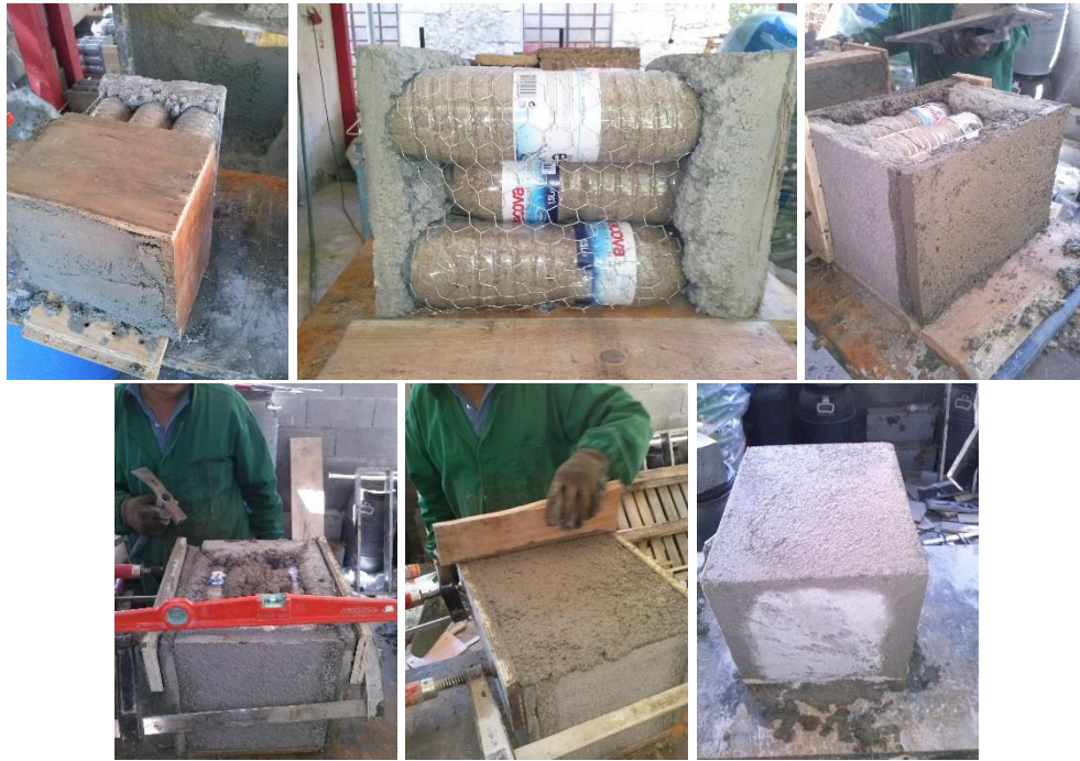
Figura 4.17. Procedimento de execução dos prismas
