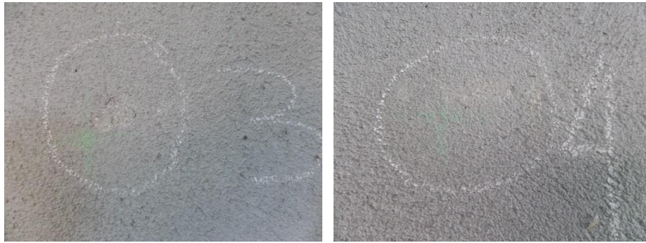
Figura 6.15. Resultado - 3 e 4 - do ensaio de corpo duro na face de argamassa que contém areia 0/4
