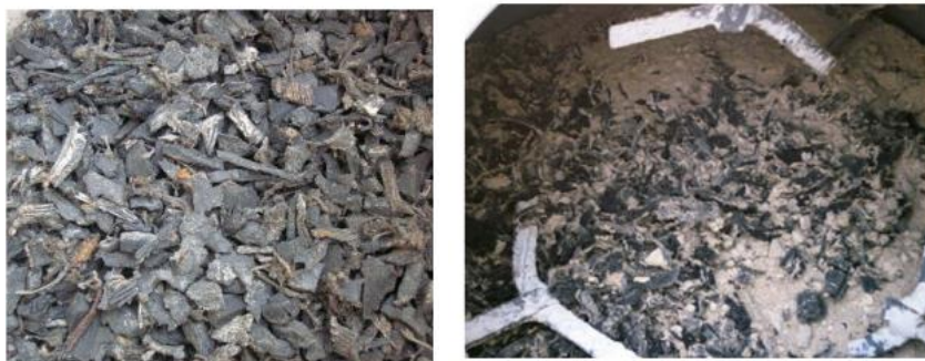
Figura 2.7. Partículas de borracha: após o processo de trituração; durante a mistura do betão (Fonte: (Fraternali et al., 2011)).
