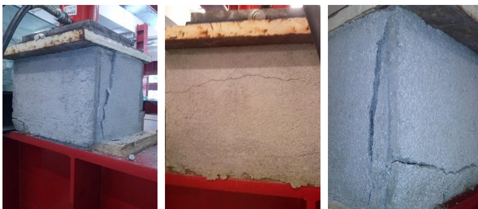
Figura 6.8. Fissuras ao longo e após o carregamento
