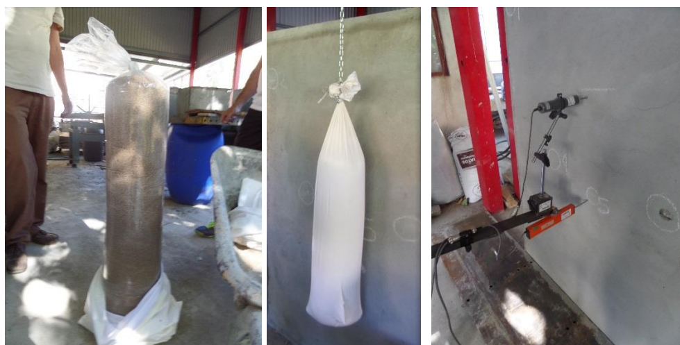
Figura 5.12. Preparação do saco para o ensaio de corpo mole assim como os defletómetros para a medição do deslocamento horizontal.
