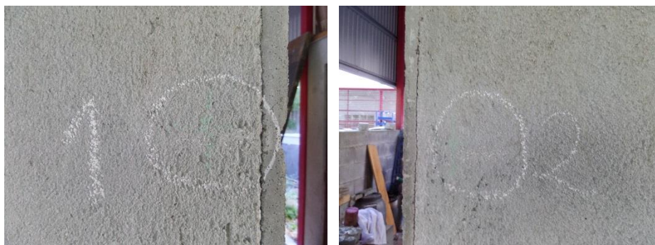
Figura 6.14. Resultado - 1 e 2 - do ensaio de corpo duro na face de argamassa que contém areia 0/4
