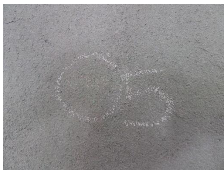
Figura 6.13. Resultado - 5 - do ensaio de corpo duro na face de argamassa que contém areia 0/2
