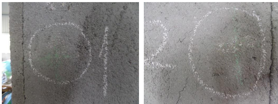
Figura 6.11. Resultados - 1 e 2 - do ensaio de corpo duro na face de argamassa que contém areia 0/2
