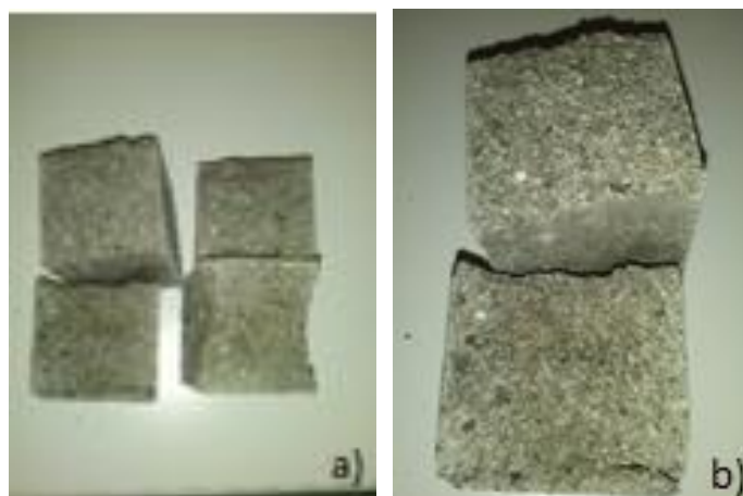
Figura 6.7. Provetes de argamassa após o ensaio de resistência à compressão
