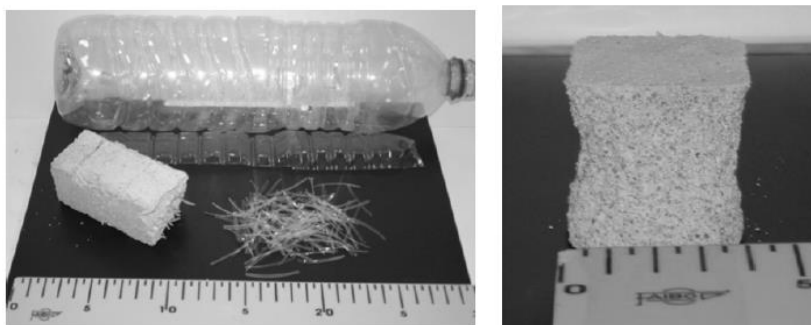
Figura 2.6. Tereftalato de polietileno (PET) de fibras recicladas; Falha típica de uma argamassa depois de teste de compressão (Fonte: Oliveira e Castro- Gomes 2011)
