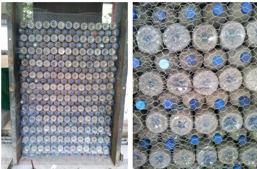
Figura 4.12. Disposição final das garrafas PET assim como posição da Tela
