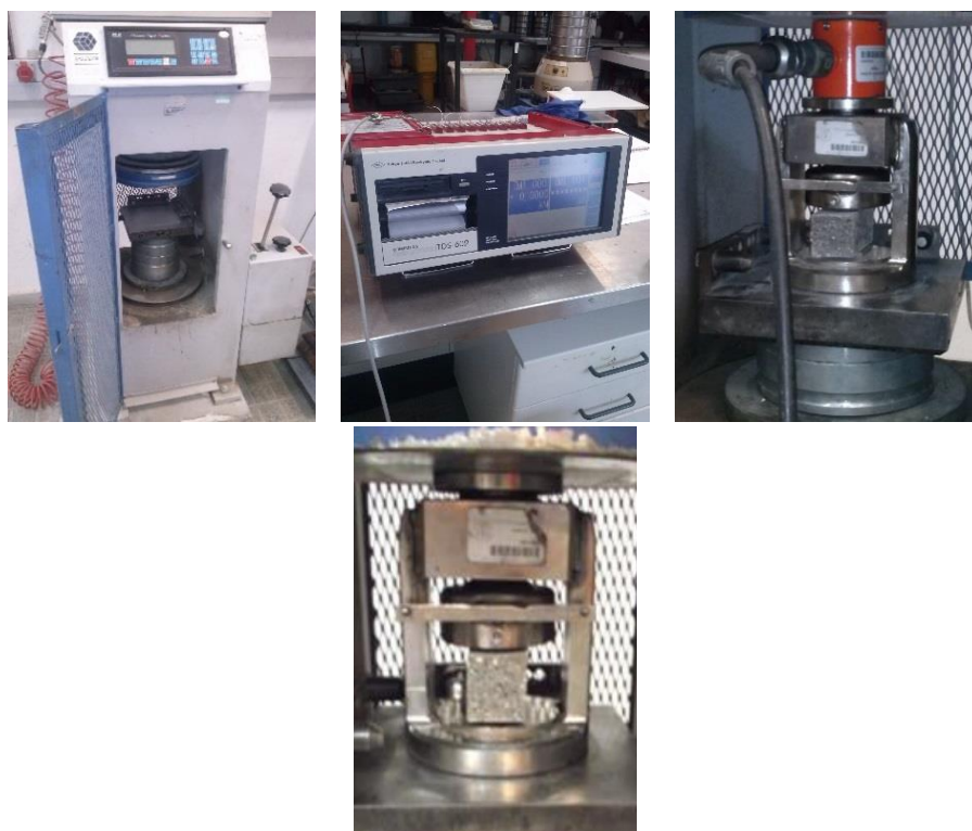
Figura 5.10. Prensa, “datalogger”, ensaio com célula de carga e ensaio sem a célula de carga
