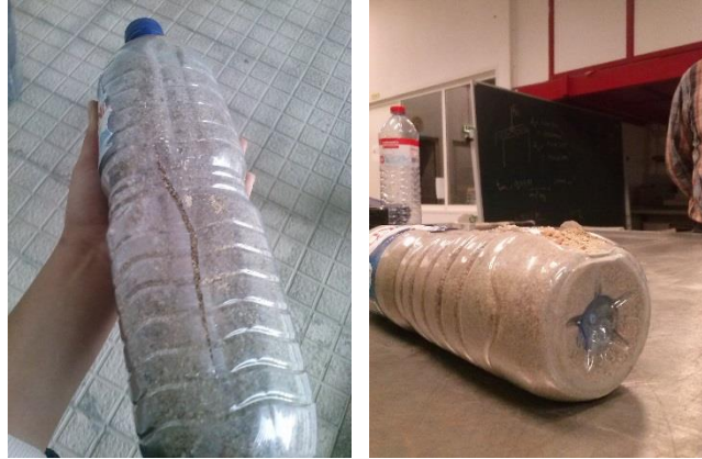
Figura 6.6. Registro fotográfico da fissura após o ensaio de resistência diametral, PET 2 e 3
