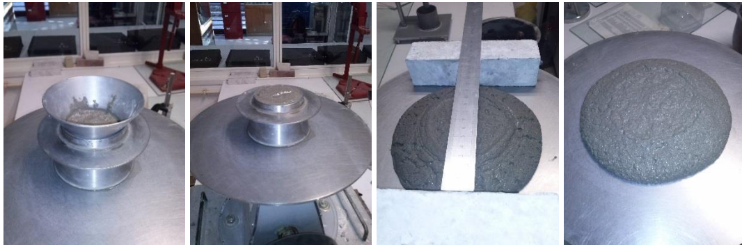
Figura 5.6. Procedimento do ensaio de espalhamento
