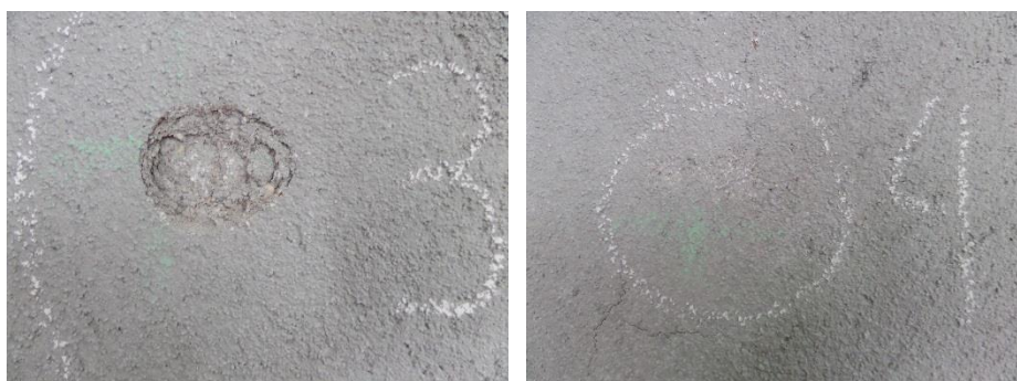
Figura 6.12. Resultado - 3 e 4 - do ensaio de corpo duro na face de argamassa que contém areia 0/2
