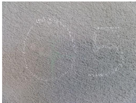
Figura 6.16. Resultado - 5 - do ensaio de corpo duro na face de argamassa que contém areia 0/4
