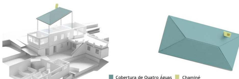
Figura 4.3.1.6 - Funcionamento da cobertura de quatro águas.
