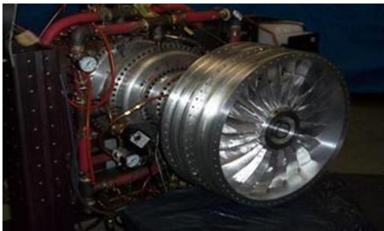
Figura 8- Turbofan com ITB em desenvolvimento pela Spytek [16].
