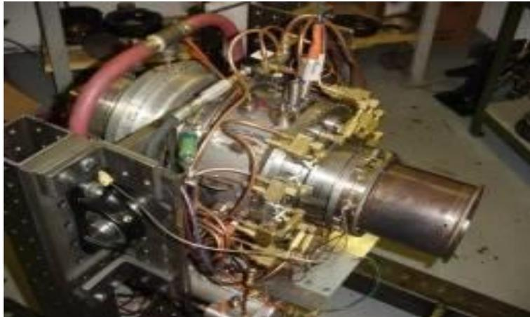
Figura 9- Turbo-eixo com ITB em desenvolvimento pela Spytek [16].
