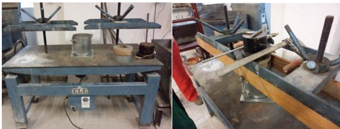
Figura A1. 4: Mesa vibratória (esquerda); fase de compactação na mesa vibratória (direita).
