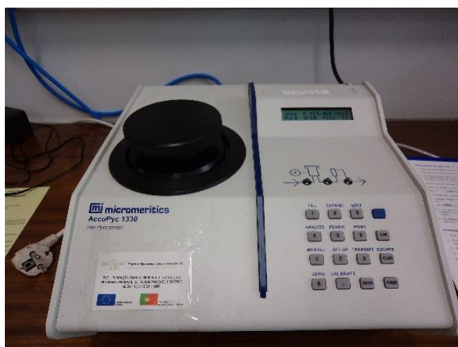
Figura A1. 1: Imagem do aparelho Micromeritics AccuPyc 1330 (Picnómetro de Hélio).
