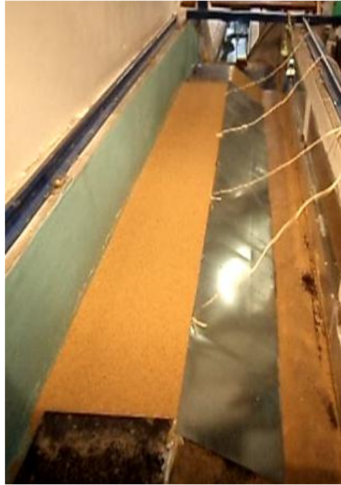
Figura A5. 14: Colocação de chapa de zinco para proteção do talude durante o estabelecimento das condições hidráulicas para os ensaios de observação do mecanismo de rotura do leito móvel.
