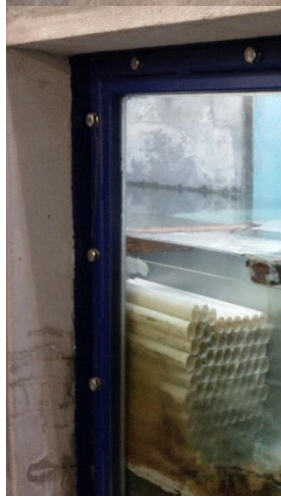
Figura A4. 3: Estabilizador de superfície livre na entrada do canal.
