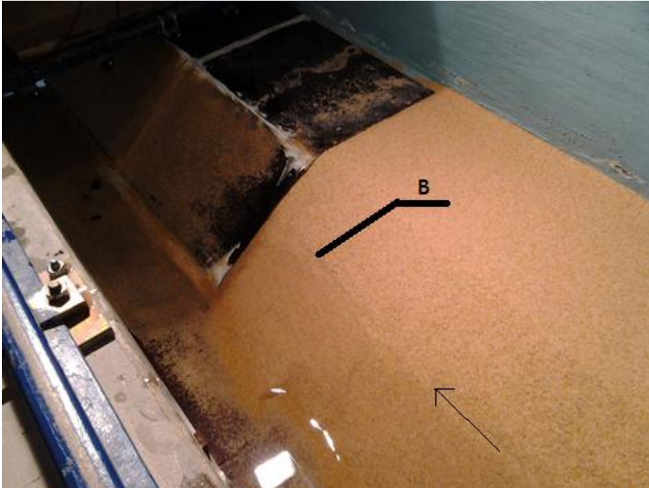
Figura 5. 5: Configuração da geometria a montante do talude após o ensaio nº 3 (B: nível a partir do qual a diminuição do nível da água passa a ser controlada apenas pelo esvaziamento do reservatório de entrada).
