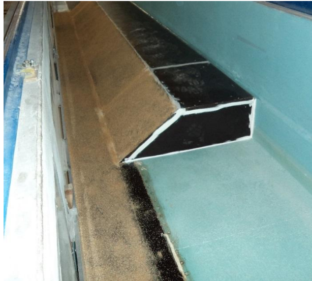
Figura A5. 9: Colocação da superfície rugosa no fundo do canal.
