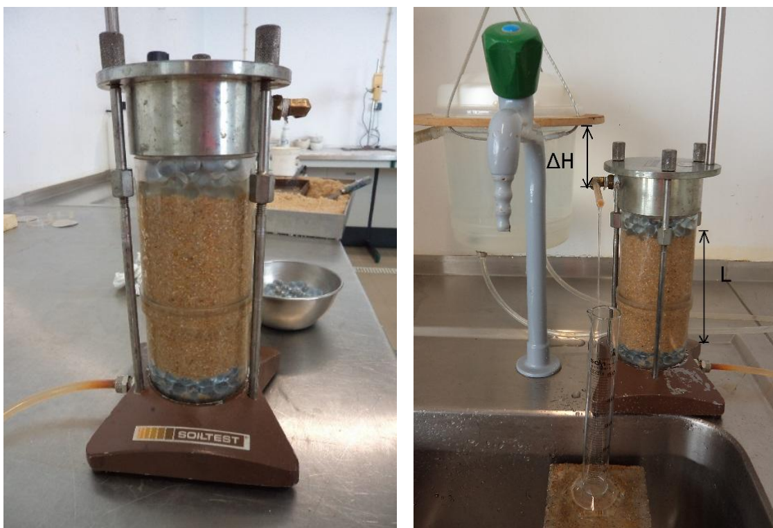
Figura A1. 6: Permeâmetro de carga constante, após a preparação da amostra de areia (esquerda); fase de ensaio (direita).
