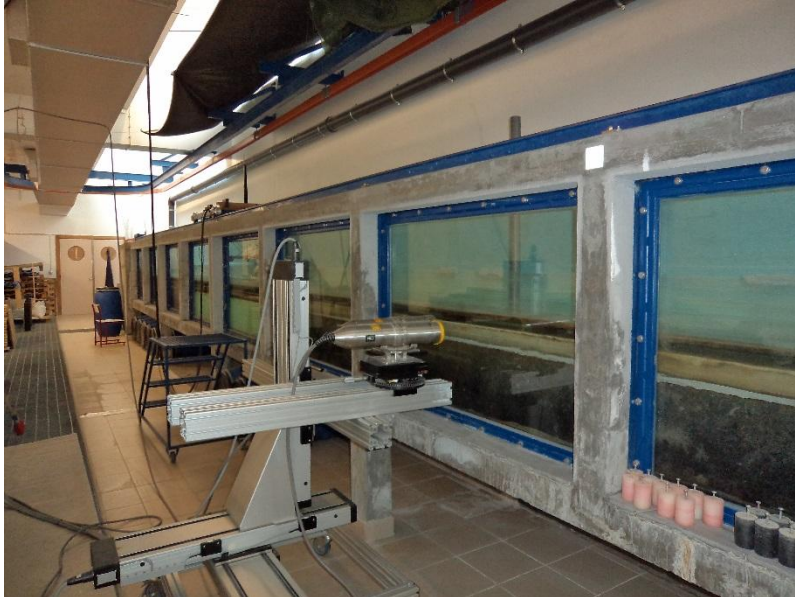
Figura A4. 1: Canal prismático onde foi construído o modelo físico.
