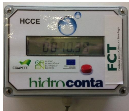
Figura A4. 7: Display digital de caudal (m 3 /h).
