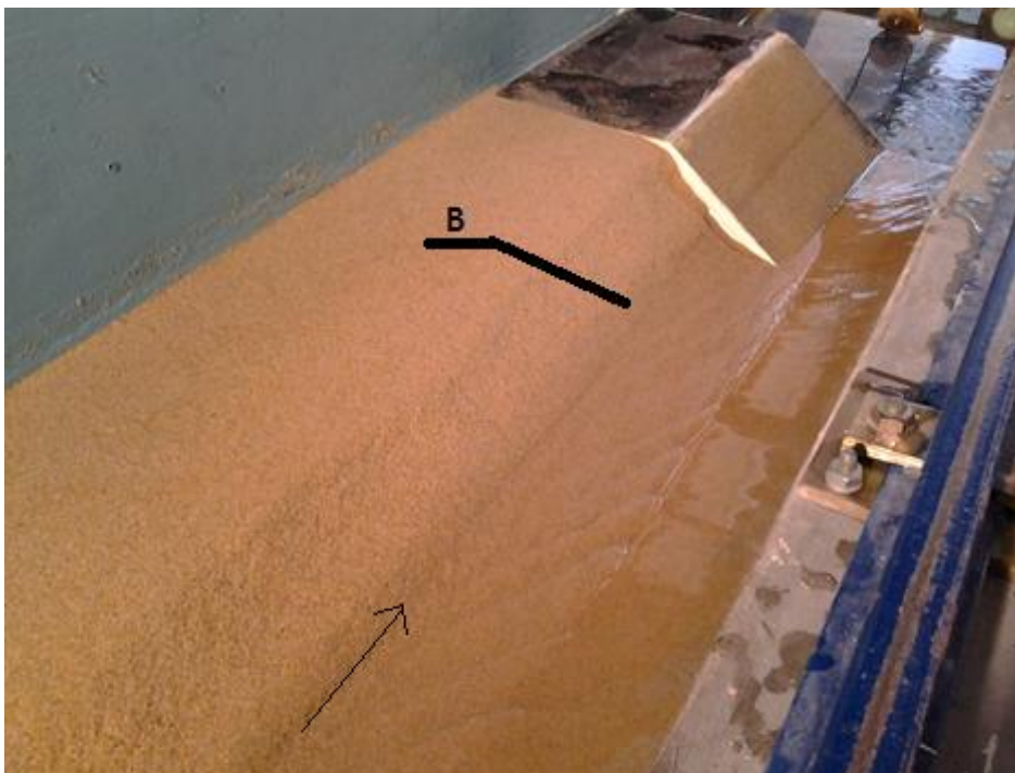
Figura 5. 4: Configuração da geometria a jusante do talude após o ensaio nº 2 (B: nível a partir do qual a diminuição do nível da água passa a ser controlada apenas pelo esvaziamento do reservatório de entrada).
