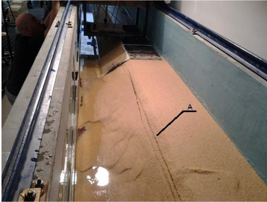
Figura 5. 1: Configuração da geometria a montante do talude após o ensaio nº 1 (A: estabilização do escoamento após a 1ª diminuição do nível da água).
