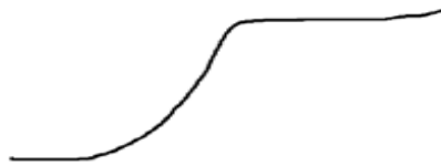
Figura 2. 2: Geometria típica de um talude íngreme de topo alto (Millet 2011).
