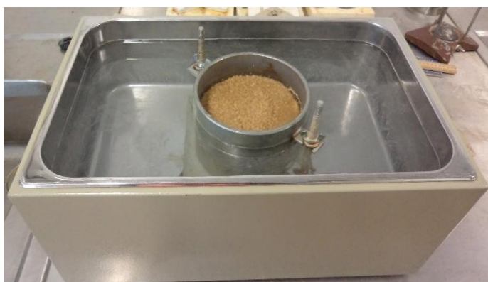
Figura A1. 5: Fase de saturação da amostra no tanque de embebição.
