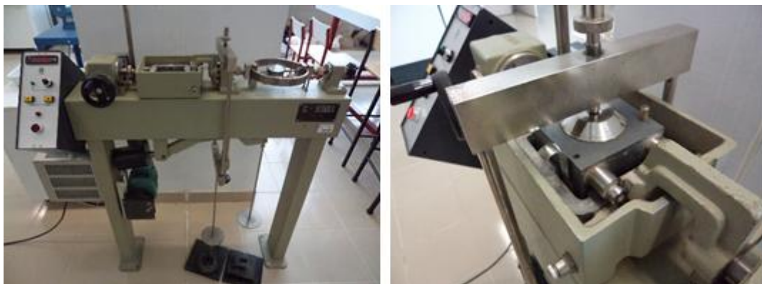
Figura A1. 8: Aparelho de corte direto (esquerda); caixa de corte (direita).
