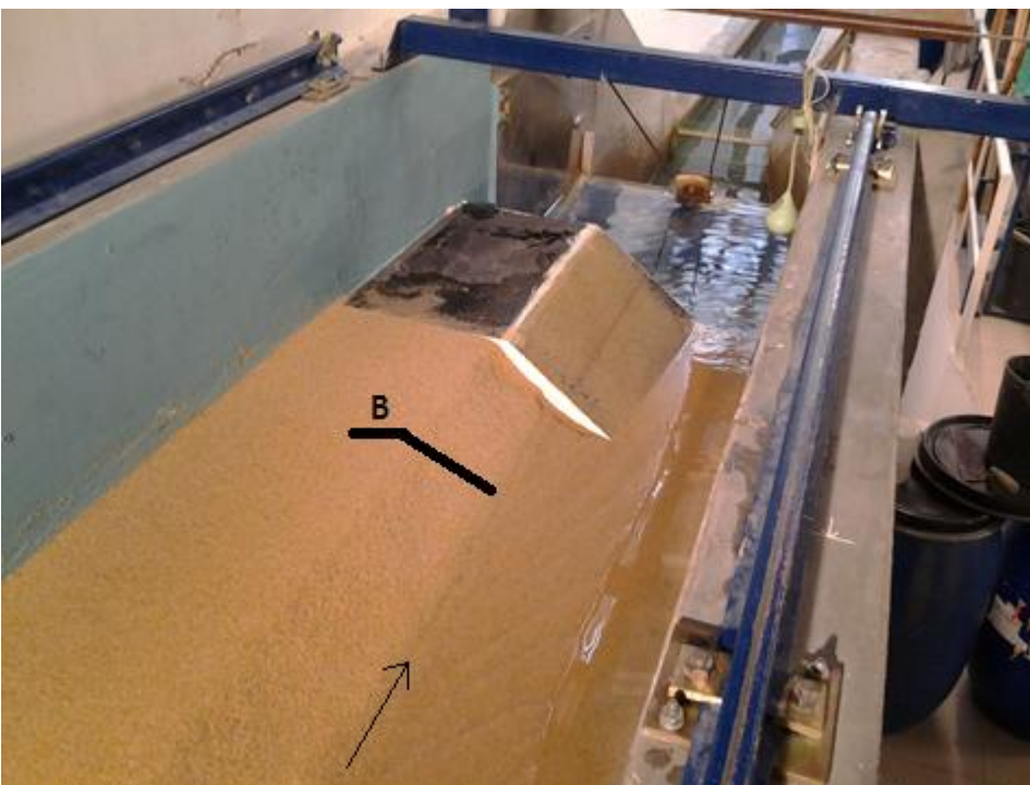
Figura 5. 6: Configuração da geometria a jusante do talude após o ensaio nº 3 (B: nível a partir do qual a diminuição do nível da água passa a ser controlada apenas pelo esvaziamento do reservatório de entrada).
