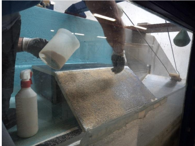
Figura A5. 8: Colocação da superfície rugosa no talude fixo (parte 2).
