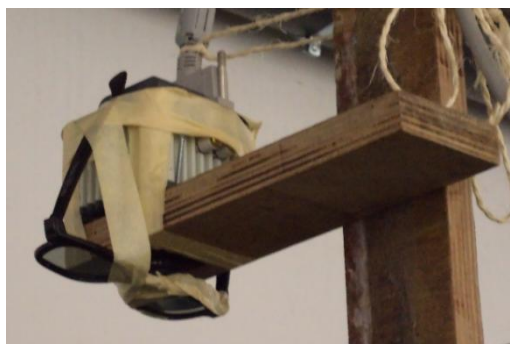
Figura 4. 7: Câmara com filtros polarizadores adaptados.
