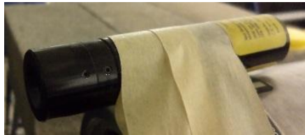
Figura 4. 3: Laser usado nos ensaios laboratoriais de medição PIV.
