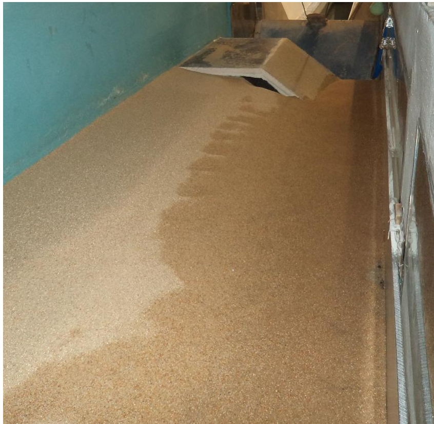
Figura 5. 7: Configuração do talude após ensaio nº 4.
