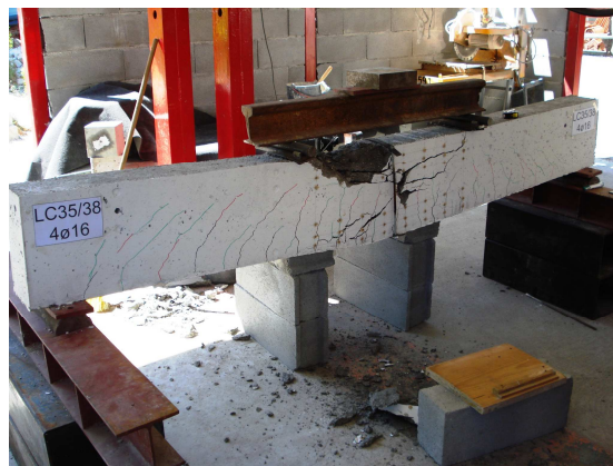
Figura 4. Rotura por esmagamento do betão.
