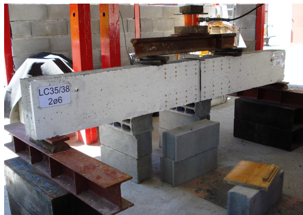
Figura 3. Viga no pórtico de ensaio.
