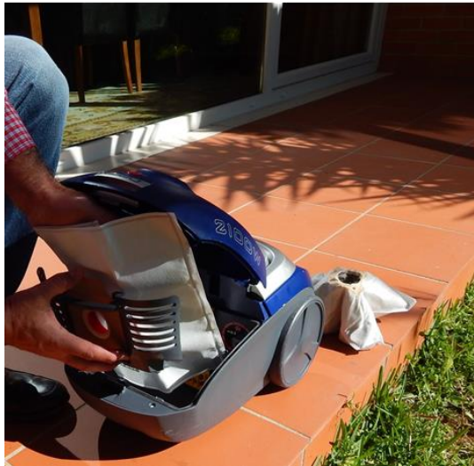
Figura 1 - Colheita das amostras de pó doméstico. Colocação do saco (Wonderbag Compact WB 305120) no aspirador no início do período de amostragem (imagem da esquerda). Aspetto do saco de aspirador após 60 dias de amostragem (imagem da direita).
