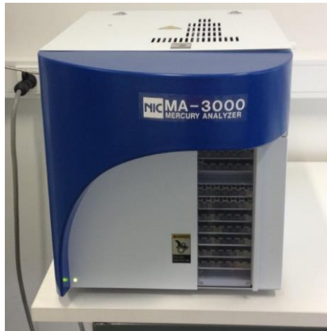
Figura 3- Equipamento utilizado para a quantificação do mercúrio total: NIC-MA-3000 (Nippon Instruments Corporation, Japan).
