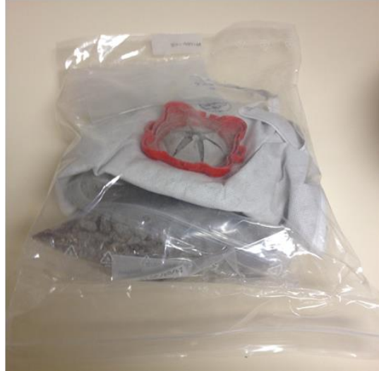
Figura 1 - Colheita das amostras de pó doméstico. Colocação do saco (Wonderbag Compact WB 305120) no aspirador no início do período de amostragem (imagem da esquerda). Aspetto do saco de aspirador após 60 dias de amostragem (imagem da direita).
