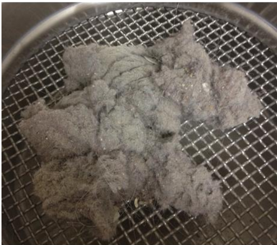
Figura 2 - Amostras de pó doméstico. Na imagem da esquerda encontra-se uma amostra de pó retirada diretamente do saco, a imagem da direita apresenta o pó depois de submetido ao processo de dupla triagem (5 mm e 500 \mu\text{m} ).
