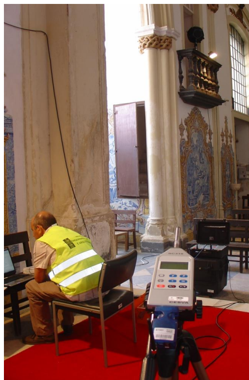
Fig. 23 - Exemplo de medições com fonte sonora colocada na posição F04 e recetor na posição R01
