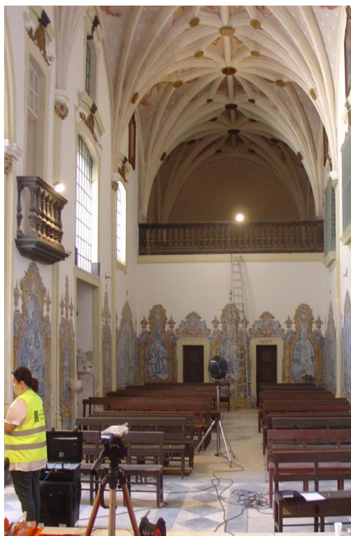
Fig. 22 - Medição com fonte sonora na posição F05 e recetor na posição R02
