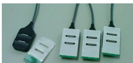
(a) Eléctrodos tipo DE-2.1 (single differential), cada sensor apresenta 2 eléctrodos
