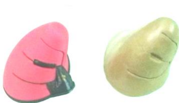
Figura 4.8 - Resultado de impressão 3D e modelo prévio em 'clay' relativo ao conceito ci.
