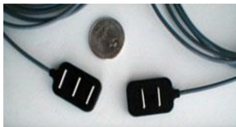
Figura 2.10 - Elétrodo diferencial duplo, à esquerda da figura, e elétrodo diferencial simples à direita (Fonte: adaptada de Agarabi et al. , 2004. Direitos de autor datados de 2004 e detidos pela editora IEEE. Reproduzida com permissão).
