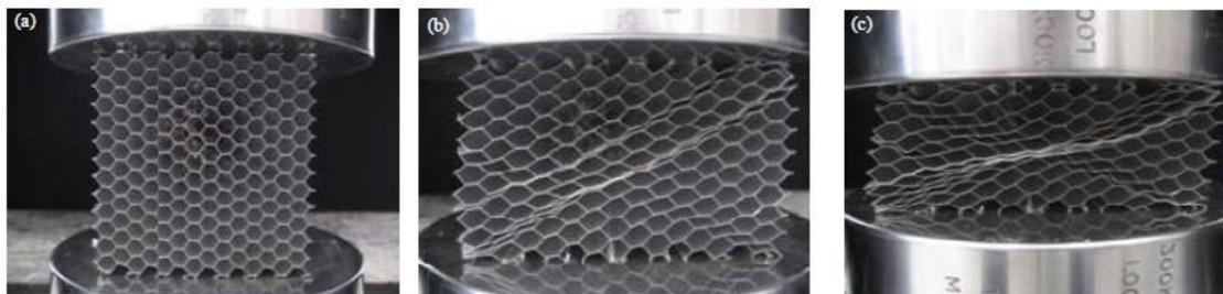
Figura 15 - Deformação do alumínio em *honeycomb* na direção W, a) sem compressão, b) compressão a 0,3 da deformação, c) compressão a 0,6 da deformação. [16]
