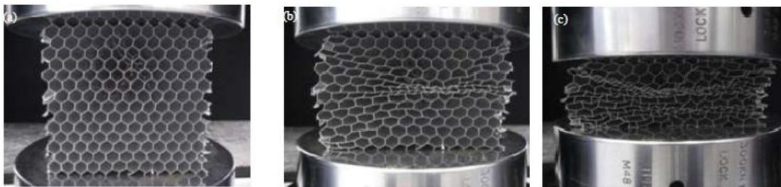
Figura 14 - Deformação do alumínio em *honeycomb* na direção L, a) sem compressão, b) compressão a 0,3 da deformação, c) compressão a 0,6 da deformação. [16]
