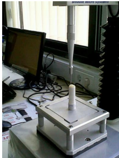
Figura 2 Texturómetro com a sonda P/2 a efetuar a análise de um lápis medicamentoso
