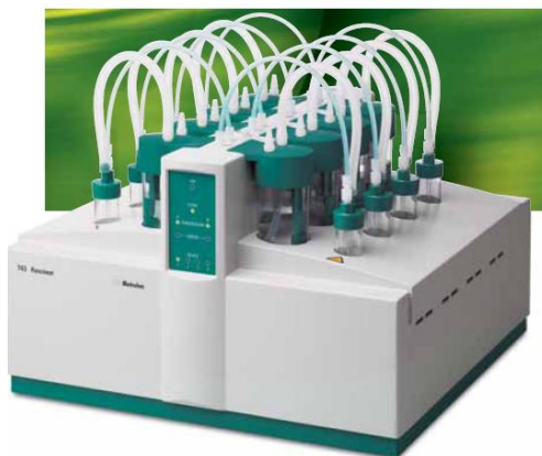
Figura 4 Aparelho Rancimat® utilizado em testes de resistência à oxidação (imagem retirada de (45))
