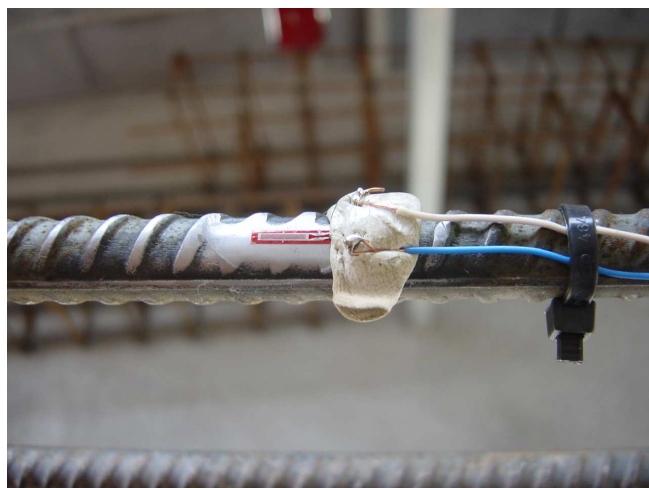
Figura 4.6. Extensômetros de resistência colados nas armaduras
