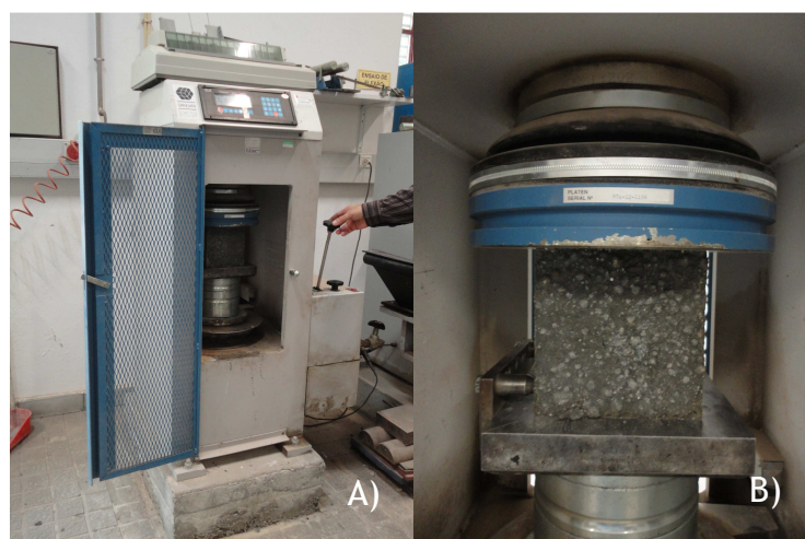
Figura 4.9. Ensaio à compressão de um provete de betão (A- Máquina; B- Pormenor)
