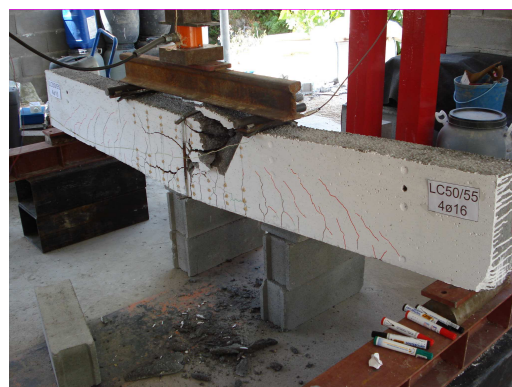
Figura 4.25. Rotura da viga S3-60,43-2,03
