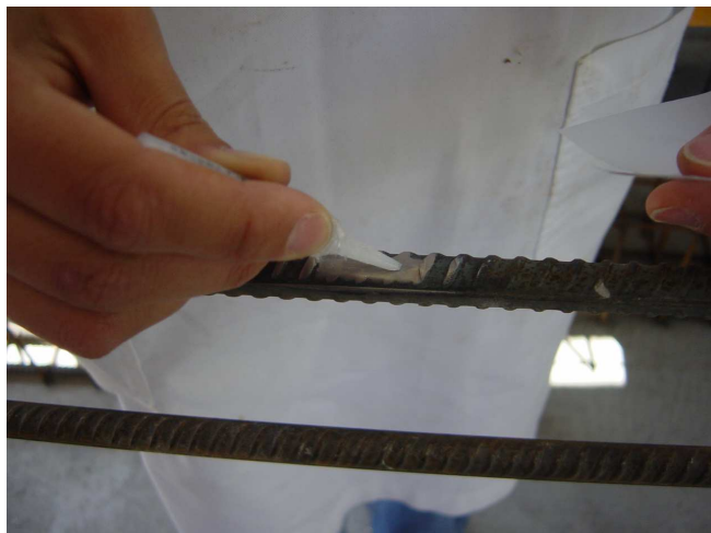
Figura 4.5. Colagem dos extensómetros de resistência nas armaduras
