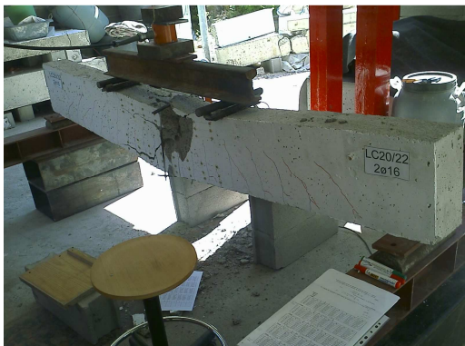
Figura 4.22. Rotura da viga S1-28,50-0,99
