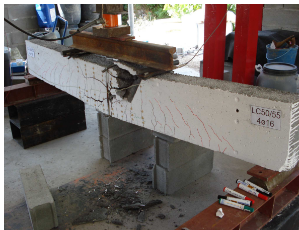
Figura 4.20. Viga S2-43,92-0,99 (pormenores da fissuração e da rotura)
