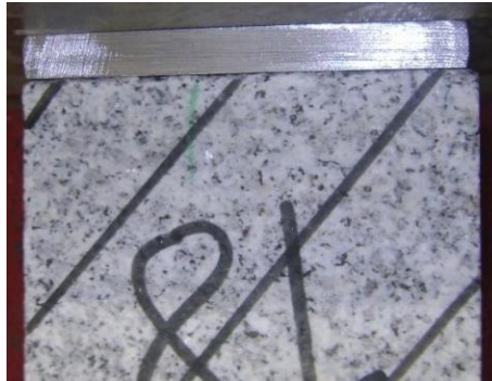
Figura 5.53: Pormenor da zona de contacto entre a chapa e o provete 18, na zona por onde se iniciou a rotura
