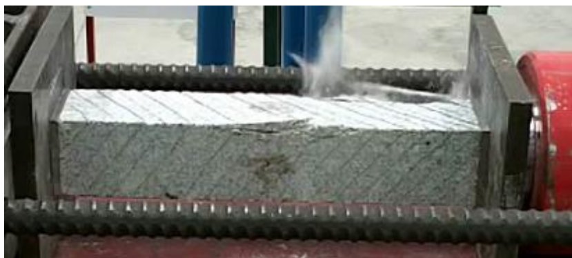
Figura 5.19: Desenrolar do processo de rotura do provete 3 (macaco hidráulico à direita)
