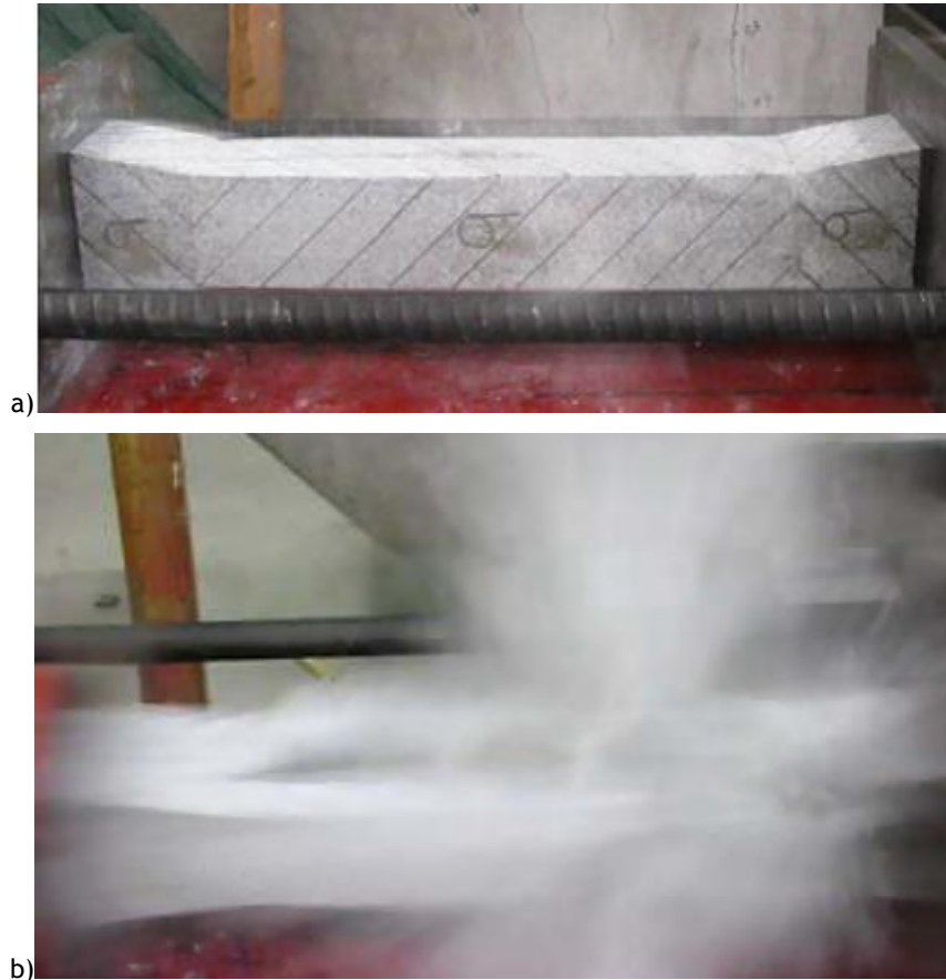
Figura 5.31: Sequência de rotura do provete 9: a) Formação da microfissura entre as faces E1 e E2; b) Rotura (macaco hidráulico à esquerda)
