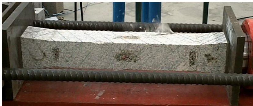
Figura 5.20: Início da rotura na zona central do provete 4, faces E1 e E4 (macaco hidráulico à direita)
