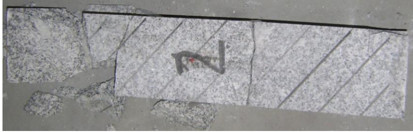
Figura 5.17: Reconstituição do provete 2, faces E1 (macaco hidráulico à esquerda)
