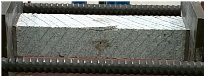
Figura 5.18: Destacamento de aresta no centro do provete 3, faces E1 e E4 (macaco hidráulico à direita)
