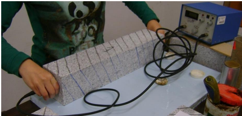
Figura 5.13: Realização do ensaio de ultrassons
