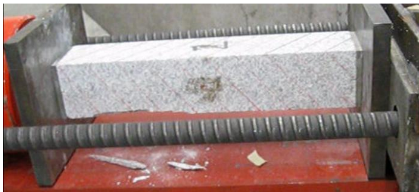
Figura 5.16: Destacamento de uma aresta do provete 2 (macaco hidráulico à esquerda)
