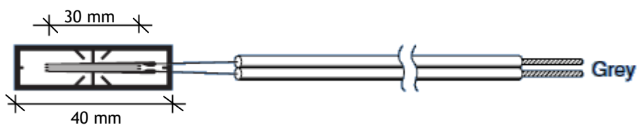
Figura 5.4: Extensómetro do tipo PFL-30-11-1L usado no ensaio [n]
