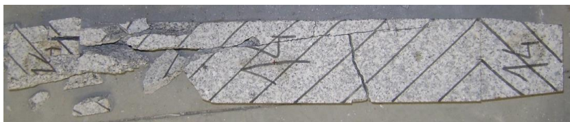
Figura 5.45: Reconstituição do provete 14, face E3 (macaco hidráulico à esquerda)
