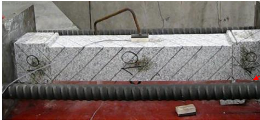
Figura 5.32: Destacamento da zona acima da ranhura do capitel do provete 10 (macaco hidráulico à esquerda)
