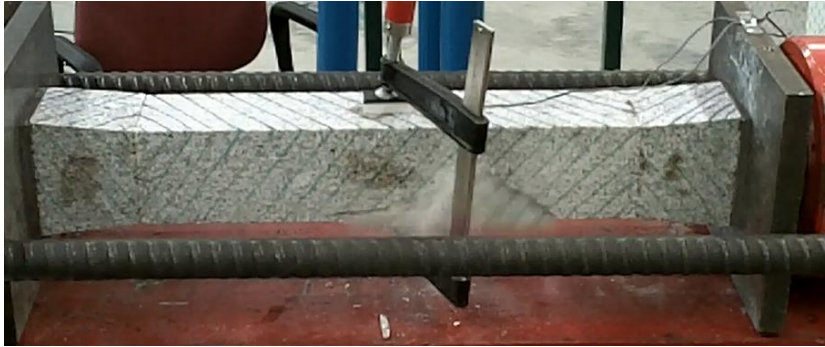
Figura 5.22: Rotura do provete 5, forte libertação de pó
