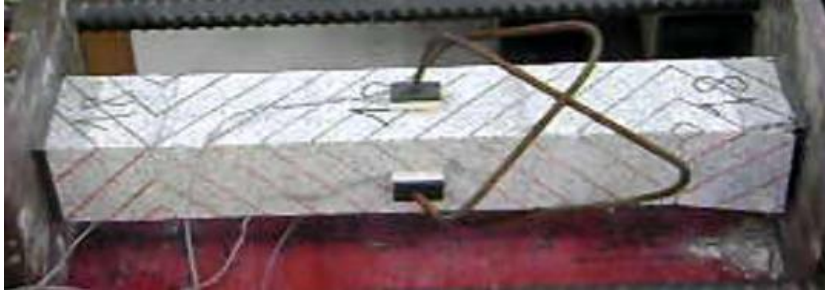
Figura 5.52: Destacamento da face E3 do “capitel” do provete 18 (macaco hidráulico à esquerda)
