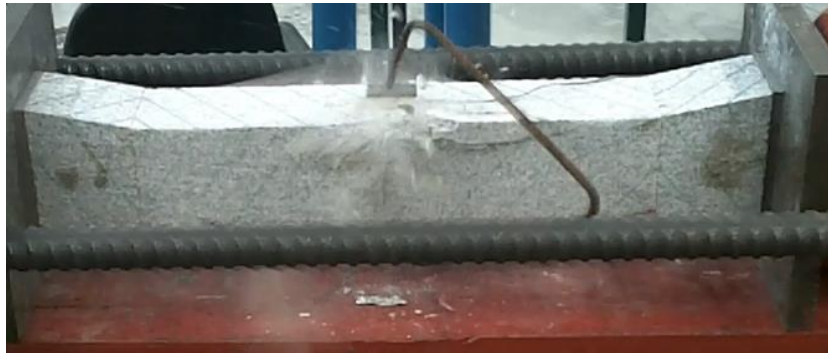
Figura 5.29: Rotura do provete 8 (faces E1 e E4)
