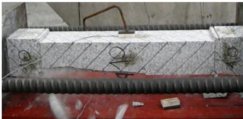
Figura 5.33: Destacamento de aresta entre as faces E2 e E3 do provete 10
