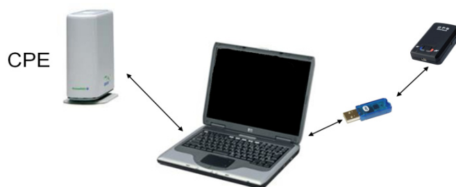
Figura 8.14 – Ligação CPE, computador e receptor GPS.
