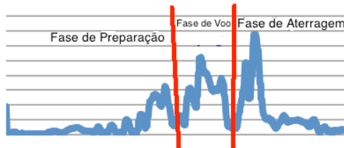
Figura 4.2 - Gráfico que representa os valores dos vetores magnitude das saídas X, Y e Z do (subtraindo o valor dos vetores magnitude obtidos a partir das saídas (X, Y e Z) do sensor de gravidade) recolhidos durante um salto pelo Smartphone , com as fases de um salto identificadas
