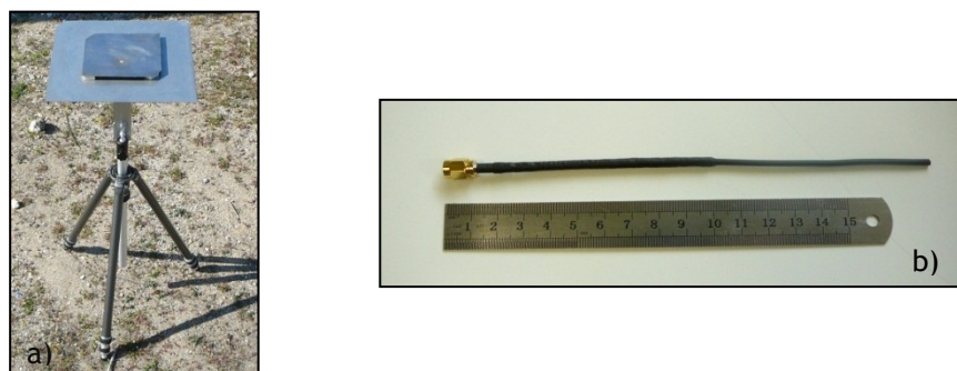
Figura 3.9 - Antenas de 900 MHz: a) solo, b) aeronave.
