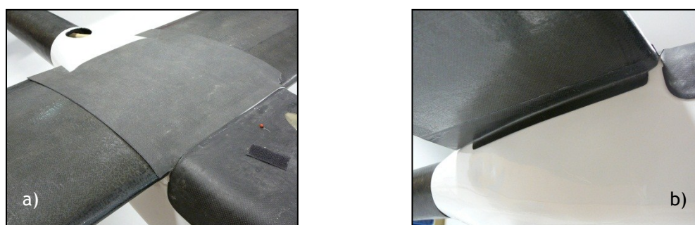
Figura 2.4 - Vista das Carenagens: a) extradorso, b) intradorso.
