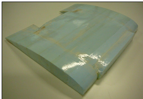
Figura 2.6 - Molde construído para laminação da carenagem superior.
