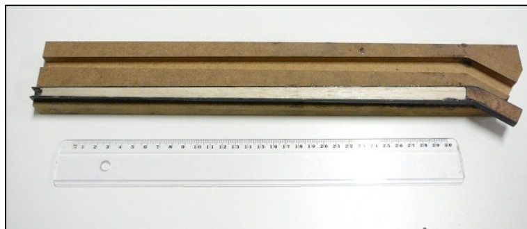
Figura 3.4 - Longarina da empenagem horizontal, juntamente com o seu molde.
