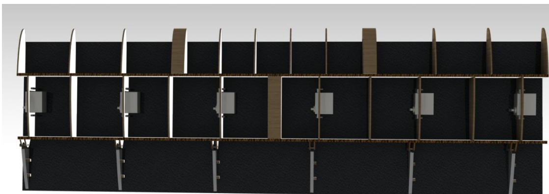
Figura 16: Pormenor estrutural do modelo CAD (CatiA V5) da asa com o flape continuo
