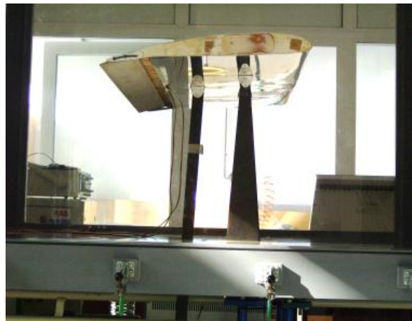
Figura 11: Flape de curvatura variável [20]
