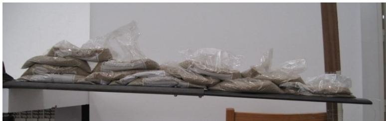
Figura 10: Protótipo da asa de envergadura variável: testes de carregamento (13,5kgf) [18]
