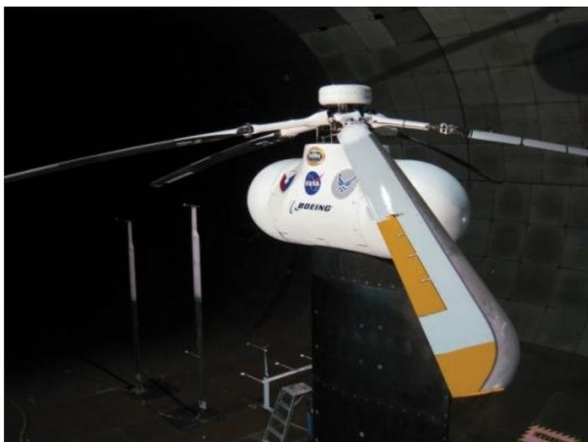
Fig. 3 - Aplicação de actuadores PZT no bordo de fuga numa pá de helicóptero. [14]
