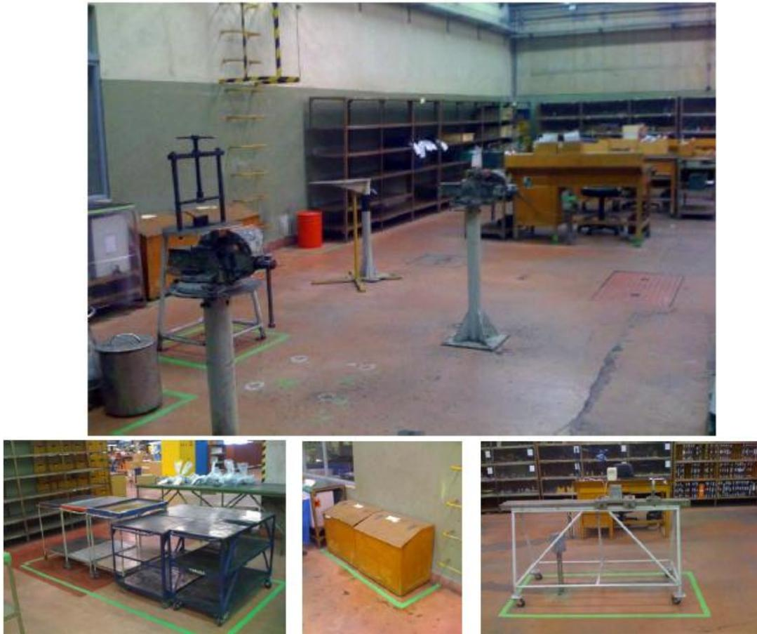
Figura 3.12 - Grupo de Acessórios Mecânicos Depois da Aplicação dos 5 S
