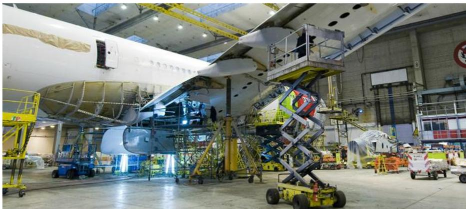
Figura 4.7 - Exemplo da utilização de plataformas elevatórias na TAP ME
