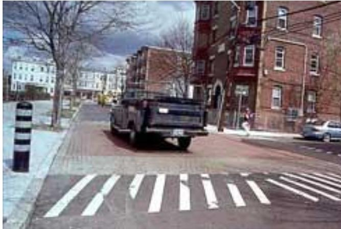
Figura 61. EXEMPLO DE UMA PASSADEIRA SOBRELEVADA [8, 2010]
