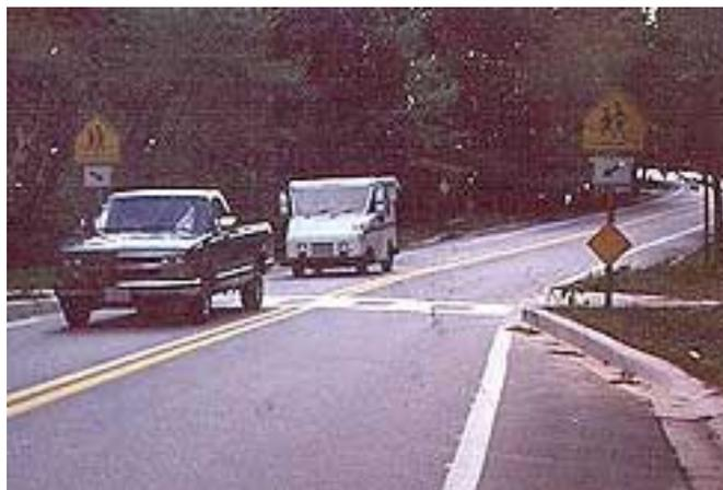
Figura 57. EXEMPLO DA APLICAÇÃO DE UM ESTRANGULAMENTO [8, 2010]
