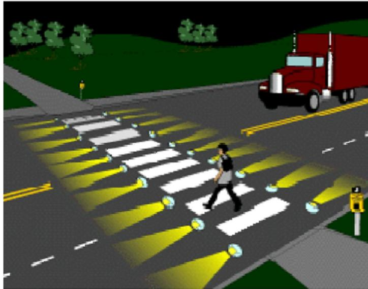
Figura 34. ILUMINAÇÃO DE UM ATRAVESSAMENTO [SILVA A.]
