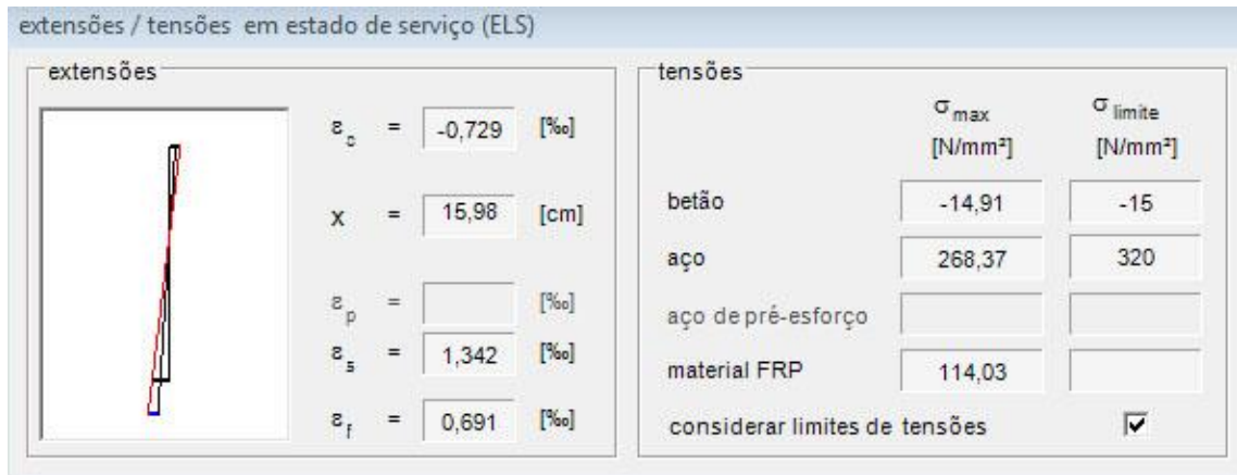
Figura 24. Extensões e tensões em estado limite de serviço (ELS).
