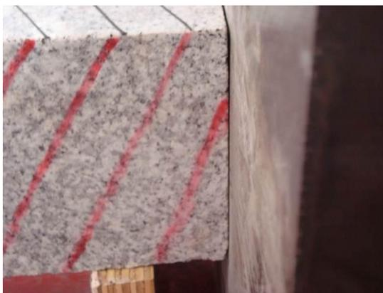
Figura 117 - Provete 1 - Contacto com a chapa de carga (Face E1)
