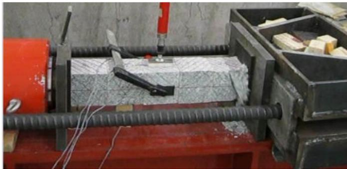
Figura 142 - Provete 8 - Início da rotura (face E1)
