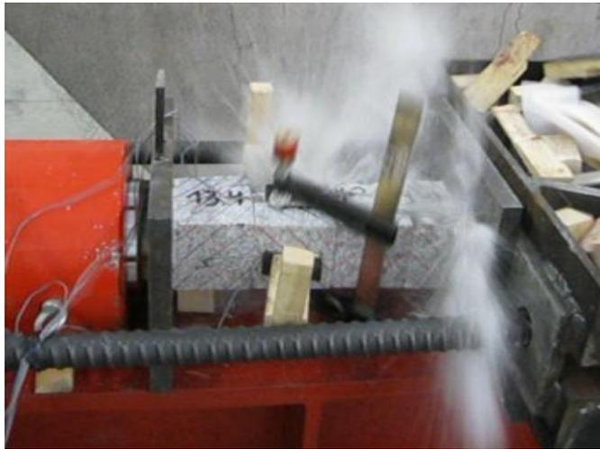
Figura 158 - Provete 14 - Rotura (face E1)
