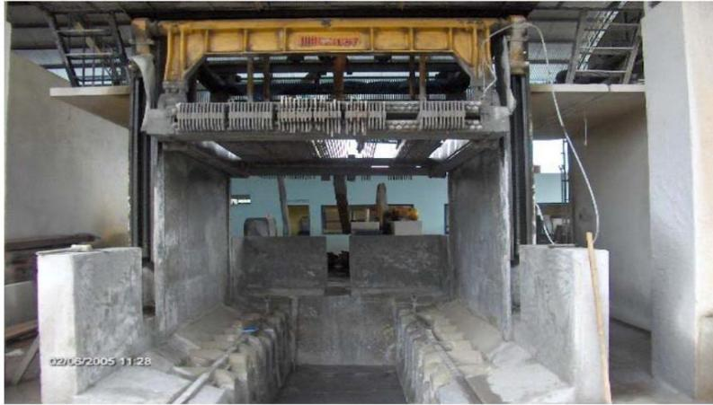
Figura 24 - Tear multi-lâminas (adaptado de [28])
