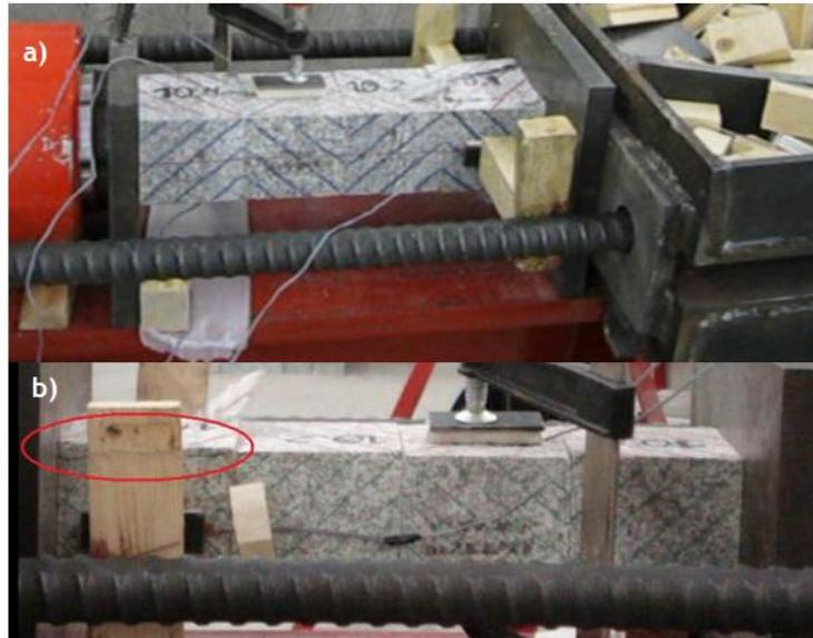
Figura 146 - Provete 10 - a e b) Início da rotura (face E1)
