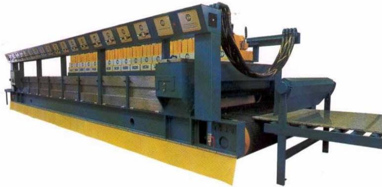
Figura 30 - Polidora de tapete transportador [28]
