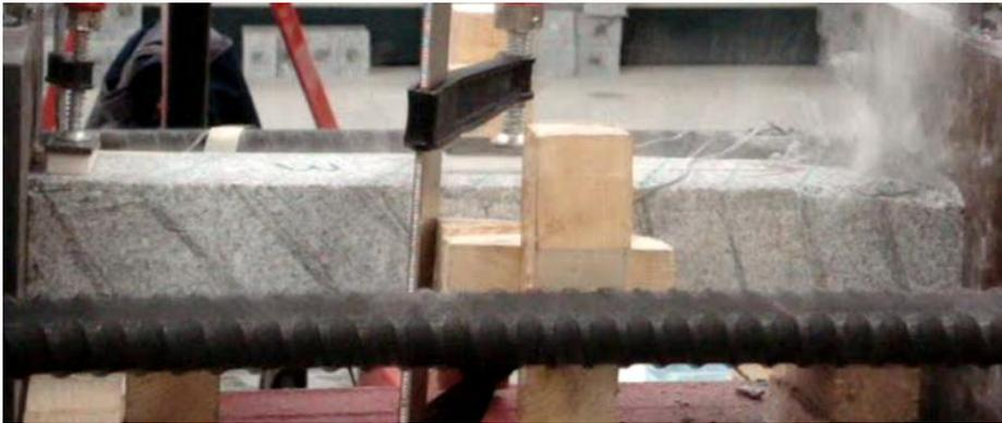
Figura 101 - Provete 3 - Planos de rotura e cunha resultante (face E0, macaco à direita)
