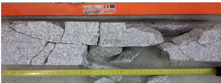
Figura 100 - Provete 5 - Vista da face E1 (macaco à esquerda)
