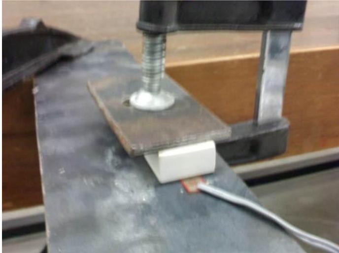
Figura 95 - Calibração dos extensómetros
