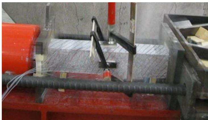
Figura 114 - Provete 4 - Início da Rotura (saída de pó da face E4 - macaco à esquerda)
