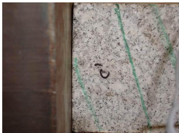
Figura 104 - Provete 2 - Contacto com a chapa de carga (face E0)
