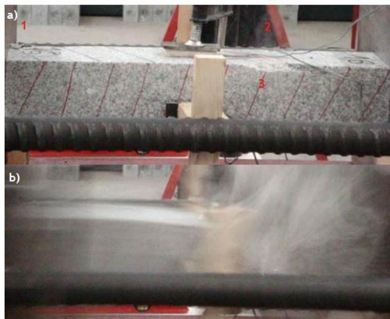
Figura 125 - Provete 16 - a) Sequência de rotura; b) Rotura (face E0 - macaco à direita)
