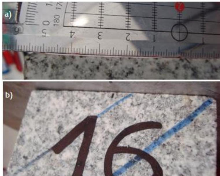
Figura 124 - Provete 16 - a) Defeito da superfície; b) Contacto com chapa (face E3)
