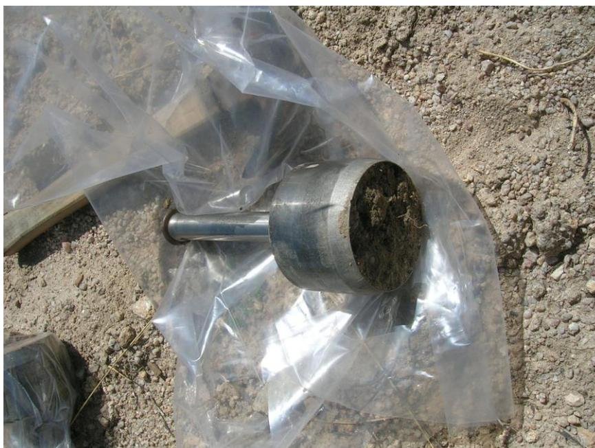
Figura 2.11. - Amostrador de solo para determinação do peso volúmico
