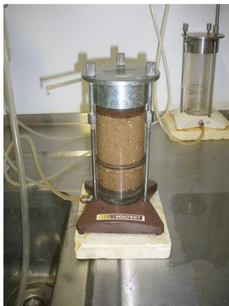
Figura 2.13. - Permeâmetro para determinação da condutividade hidráulica
