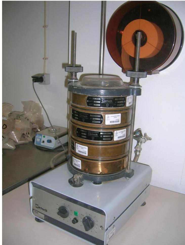
**Figura 2.3.** - Peneiração para determinação da curva granulométrica
