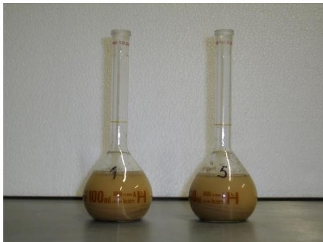
Figura 2.10. - Picnómetro para determinar a densidade
