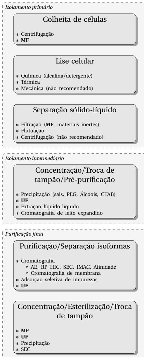
Figura 1.1: Esquema genérico de um processo de purificação de DNA plasmídico, adaptado de [12, 20, 1]. Operações de MF e UF podem ser encontrados em praticamente todas as fases do processo. MF - Microfiltração, UF - Ultrafiltração, AE - Cromatografia de permuta aniônica, RP - Cromatografia de fase reversa, HIC - Cromatografia de interação hidrofóbica, SEC - Cromatografia de exclusão molecular, IMAC - Cromatografia de afinidade com metal imobilizado.
