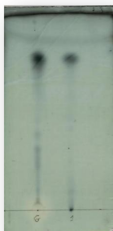
Figura 69 - TLC da goma resultante da biotransformação com A. niger da fermentação a 13 dias. À esquerda a referência (guaiol) e à direita do resultado da biotransformação.
