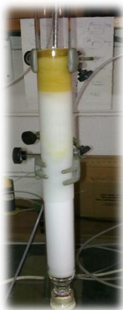
Figura 57 - Coluna cromatográfica do resultado da fermentação a 5 dias.
