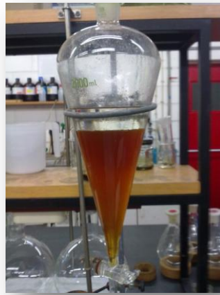
Figura 43 - Extração líquido - líquido. São visíveis a fase aquosa a castanho e a fase orgânica incolor.
