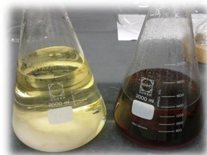
Figura 44 - Fase orgânica à esquerda e à direita encontra-se a fase aquosa, resultado da extração líquido - líquido.
