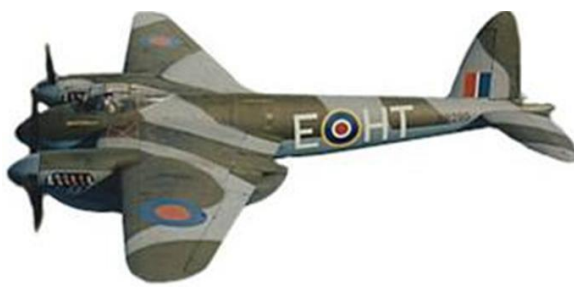
Figura 1.5 - Aplicações de painéis sanduíche: a) Mosquito TT35 TA639, b) Estrutura de um barco.
