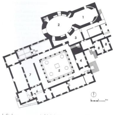
Figura 47. Planta do Mosteiro de Santa Maria Maceira Dão. 1-Capela-mor; 2-Nave; 3-Sacristia; 4-Sala do Capitulo; 5-Claustro; 6-Cozinha; 7-Refeitório; 8-Tulha.
