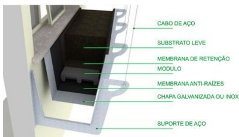
FIG.4 Esquema de suporte de vegetação ao longo dos pisos.
