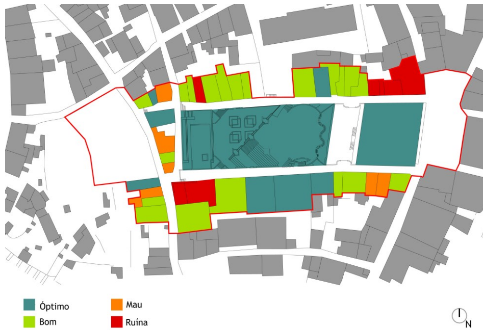
FIG.57 Planta geral de conservação de imóveis.
