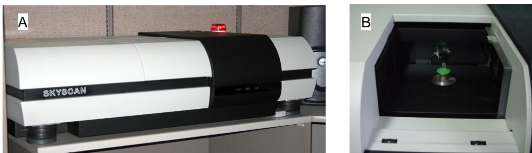
Figura 20 - \mu\text{CT} scanner Skyscan d1172 - 1.3Mpix (A) e sua câmara de aquisição (B).
