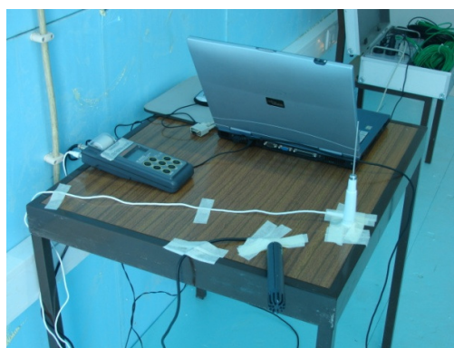
Figura 4.22 - Termohigrómetro e sondas de temperatura e humidade relativa do ar interior.
