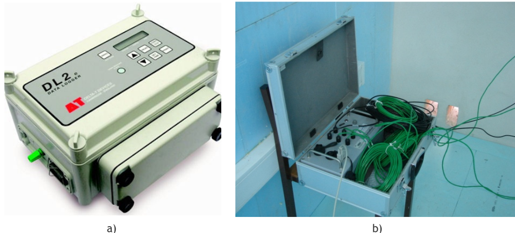
Figura 4.21 - Sistema de aquisição de dados: a) datalogger Delta-T; b) datalogger Hukseflux.
