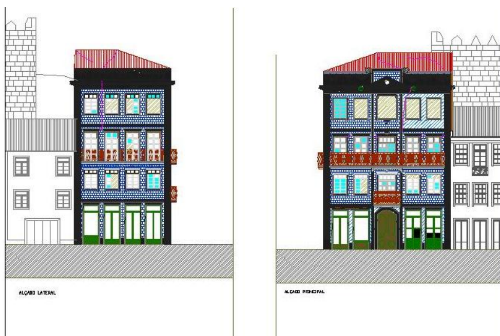
Figura 47: Desenhos das Patologias das Fachadas em AutoCad
