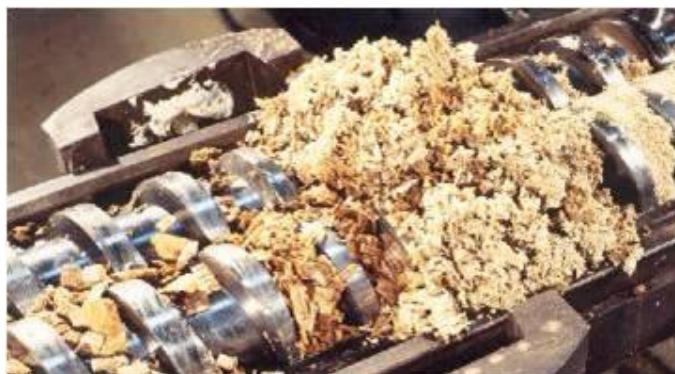
Figura 9 - Trituração de Madeira para Pasta de Papel
