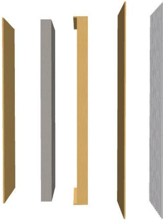
Fig. XLI - Separação de elementos de uma parede exterior (da esquerda para a direita painel isotérmico, isolamento lâ mineral, caixa estruturante em madeira, painel isotérmico e acabamento exterior).
