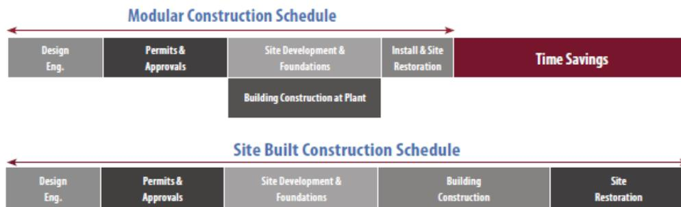
Fig. XI - Programação da construção convencional versus construção modular (Permanent Modular Construction: Annual Report 2011)
