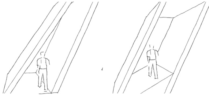
Imagem 16: Corredor com pé-direito de 3m e corredor com pé-direito de 9m Fonte: Carla Barroso 2008
