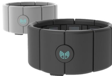
Figura 3: Myo, bracelete para controlo de computadores que lê movimentos dos braços, mãos e dedos dos utilizadores. (Fonte Wired)
