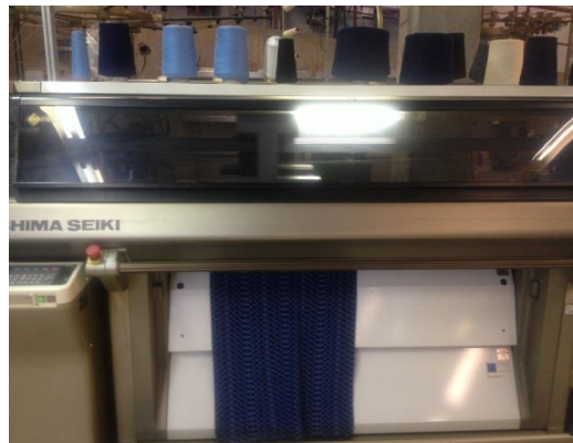
Figura 38 Malha Estruturada no Tear
