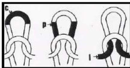
Figura 2.9 - Elementos constituintes de uma laçada (c - cabeça, p - pernas, l - pés) (Fonte: Monteiro, 2009)
