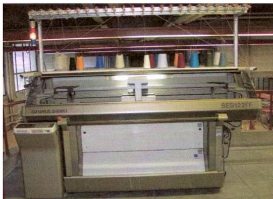
Fig. 4.1 – Tear electrónico Shima Seiki.
