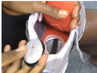
Fig. 2.9 – Sapatos Adidas com sensor de velocidade e distância Polar (ano 2006).
