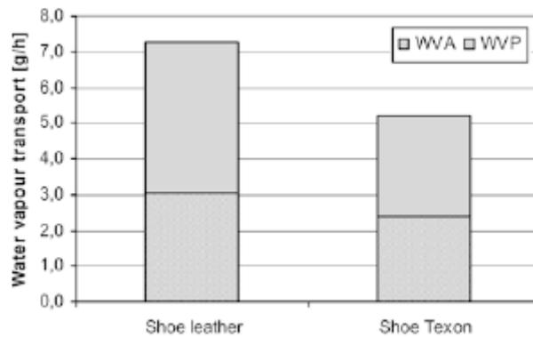
Fig. 2.2 – Absorção de vapor de água (WVA), pressão de vapor de água (WVP) e transporte de vapor de água para os dois tipos de sapatos de segurança.
