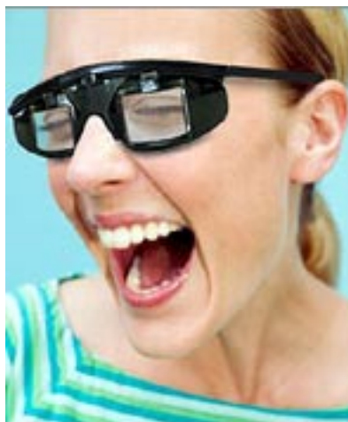
Imagem 10 – Óculos obturadores, vulgarmente designados de Shutter Glasses.
