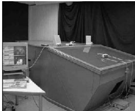
Imagem 11 – Mesa virtual, tecnicamente designada de ResponsiveWorkbench.
