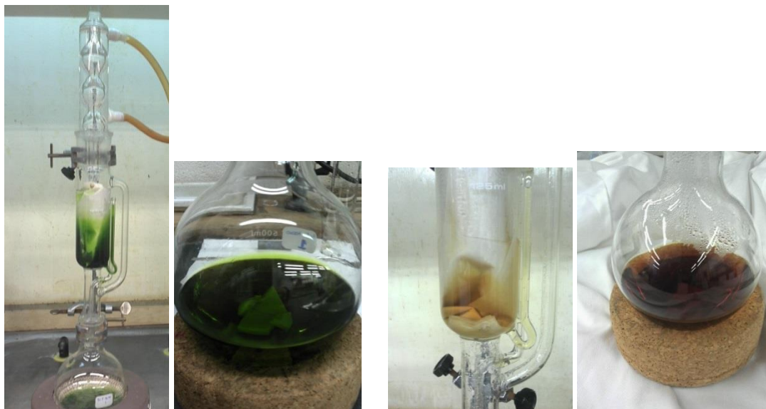
Figura 4 - Montagem da extração em Soxhlet (à esquerda: extração por polaridade crescente; e à direita extração única para obtenção do extrato aquoso de Videeiro).
