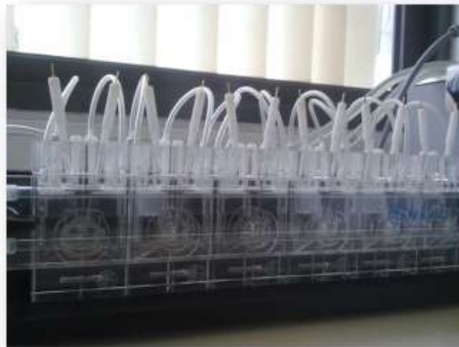
Figura 8 - - Equipamento de Ussing Chamber Warner Instruments®
