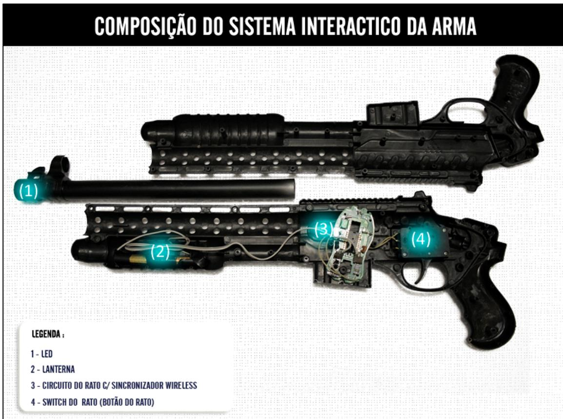
Fig. 7 - Composição e localização do sistema interactivo do interface físico.
