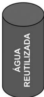
Figura 3-11 – Marcação de tubagem de sistemas de reutilização de água.
