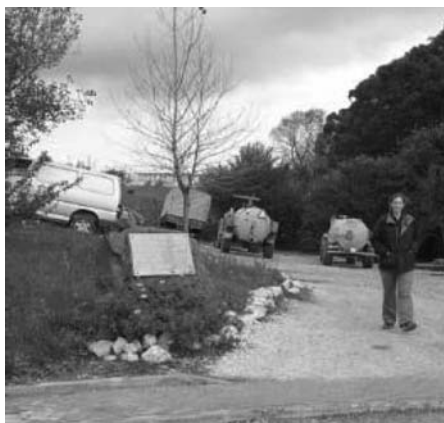
Figura 3-21 – Abastecimento de efluente da ETAR de Mafra em camião-cisterna para reutilização na construção de autoestrada.
